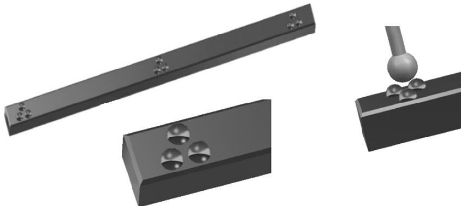
Rys. 2-8 Konceptcja wzorca samocentrującego wykorzystująca trzy powierzchnie sferyczne [23].
