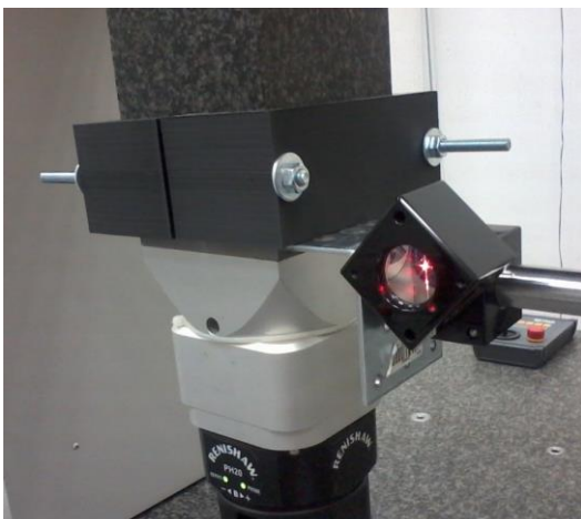
Rys. 5-24 Stanowisko badawcze układu pomiaru odległości z wykorzystaniem WMP jako układu realizującego ruch punktu pomiarowego.
