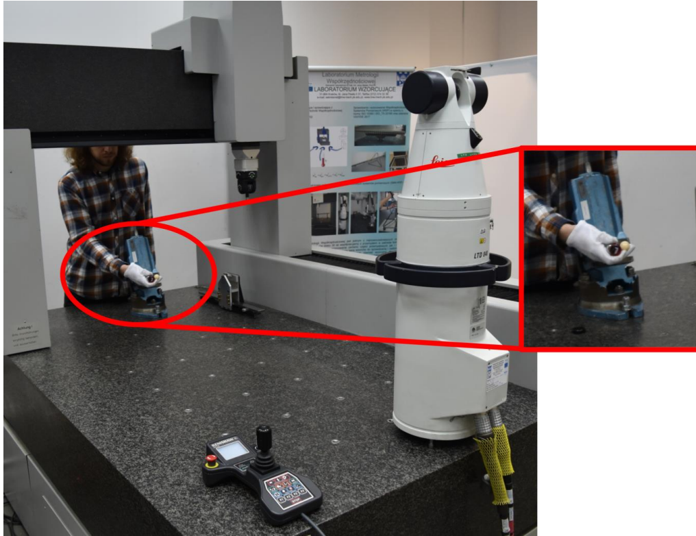
Rys. 7-3 Stanowisko pomiarowe do badań wpływu parametru RMS na niepewność pomiaru średnicy oraz błędu kształtu z wykorzystaniem kuli wzorcowej [39].
