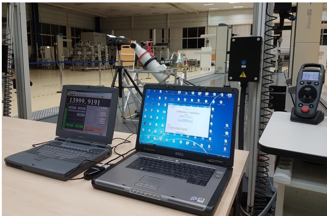
Rys. 5-33 Stanowisko pomiarowe dla badań układu pomiaru odległości LSN z zastosowaniem wytworzonego stelaża orientującego system LT, z wykorzystaniem WMP o zwiększonej przestrzeni pomiarowej jako układu realizującego przemieszczenie retroreflektora: stanowiska operatorów systemu wzorcowego, systemu badanego oraz systemu realizacji przesuwu.
