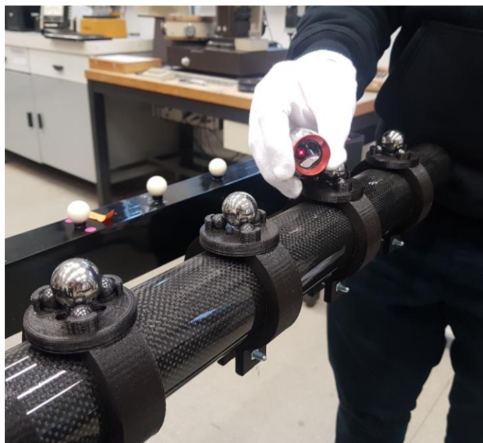
Rys. 7-4 Rekonfigurowalny wzorec kulowy typu ball-bar przystosowany do pomiaru odległości pomiędzy środkami kul centralnych, przygotowany do pomiaru laserowym systemem nadążnym z zastosowaniem standardowego retroreflektora typu SMR. Na drugim planie standardowy wzorec kulowy typu ball-bar.
