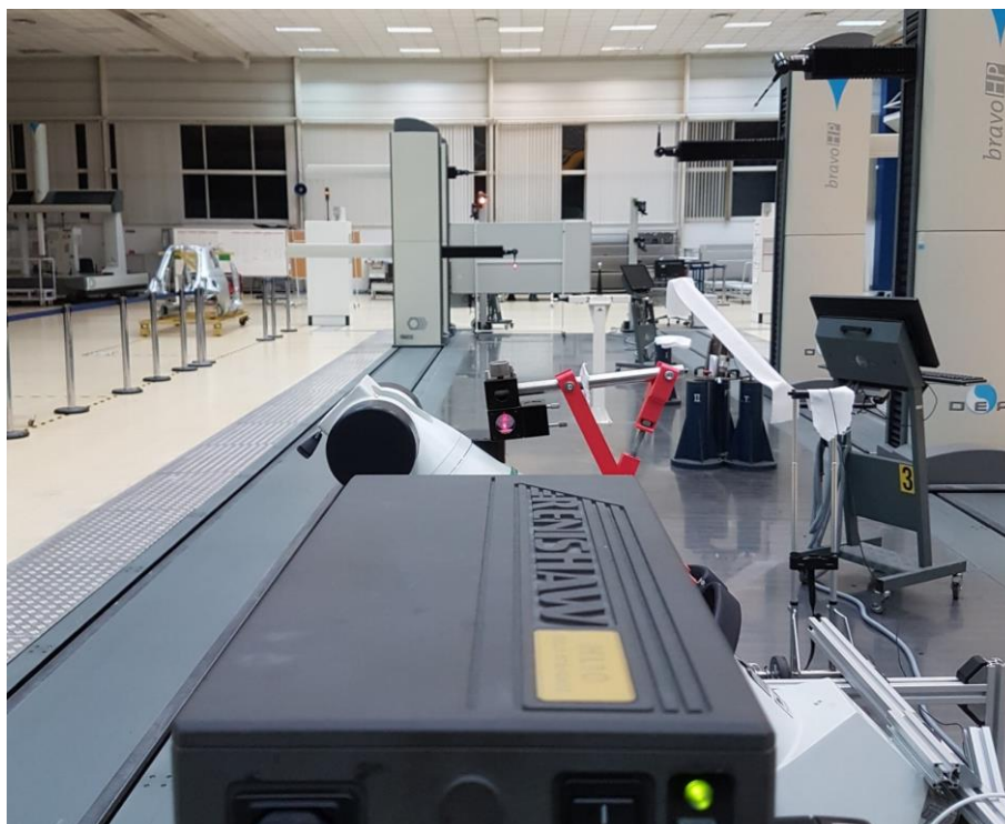
Rys. 5-32 Stanowisko pomiarowe dla badań układu pomiaru odległości LSN z zastosowaniem wytworzonego stelaża orientującego system LT, z wykorzystaniem WMP o zwiększonej przestrzeni pomiarowej jako układu realizującego przemieszczenie retroreflektora: widok stanowiska wzdłuż toru pomiarowego, pomiar w pozycji dalekiej.
