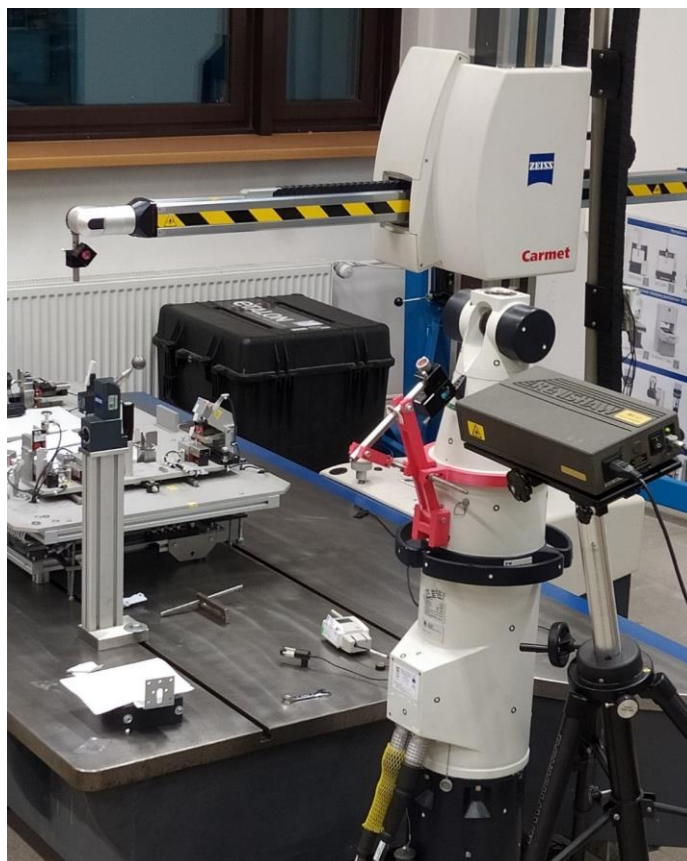
Rys. 5-26 Stanowisko badawcze interferometru LT przystosowane do pomiarów z wykorzystaniem WMP typu wysięgnikowego.
