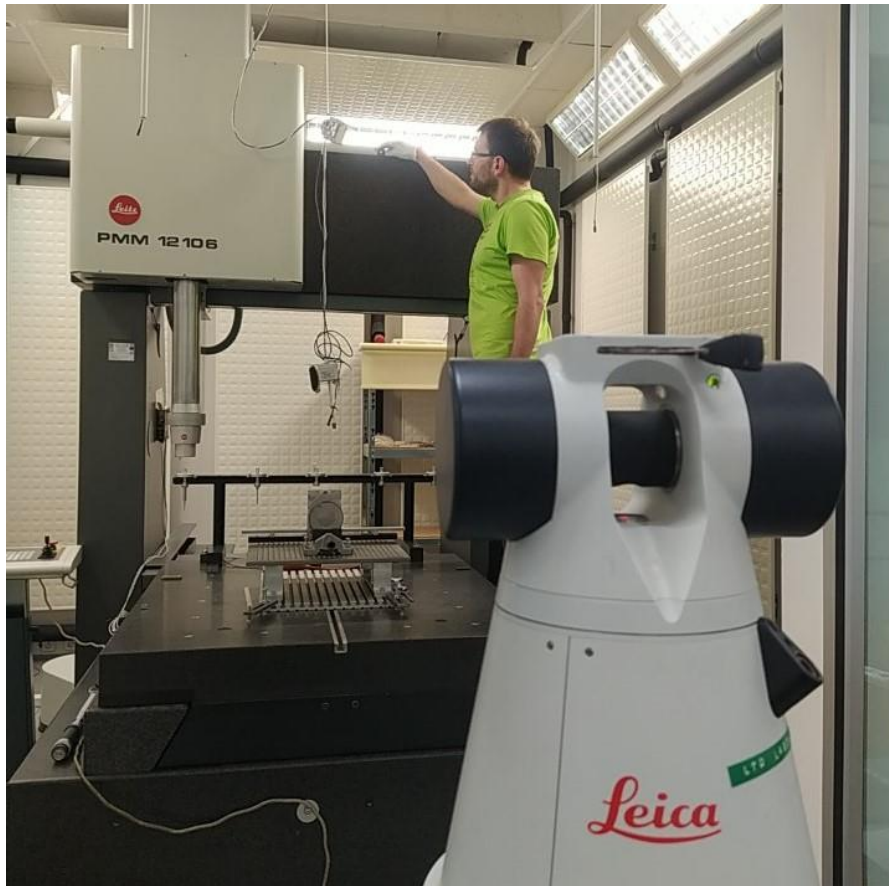
Rys. 10-2 Stanowisko pomiarowe do badania weryfikacji metody symulacyjnej w obszarze bliskim. Na stole pomiarowym WMP widoczne wzorce stosowane w metodzie wielopozycyjnej: płytka wzorcowa oraz pierścień wzorcowy.
