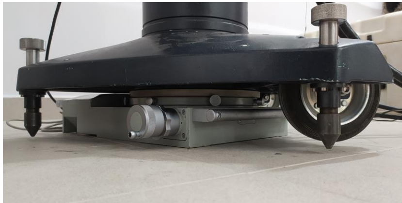
Rys. 6-2 Stolik obrotowy z systemem LT (widoczna jedynie podstawa) wykorzystywany do pozycjonowania LSN w badaniu układu pomiaru horizontalnej orientacji kątovej.
