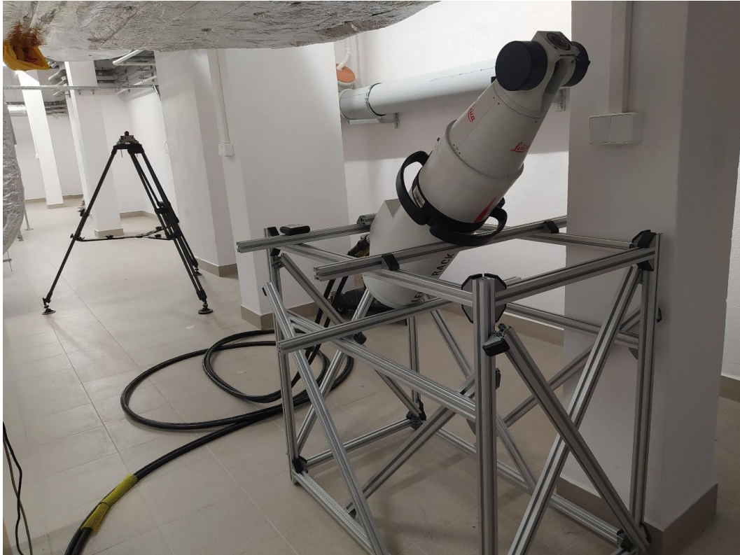
Rys. 6-7 Stanowisko pomiarowe do badań układu pomiaru wertykalnej orientacji kątowej z wykorzystaniem wytworzonego stelaża umożliwiającego orientację systemu LT.
