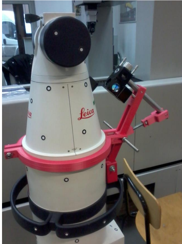
Rys. 5-23 Specjalny uchwyt umożliwiający precyzyjne pozycjonowanie rozdzielacza wiązki wykonany w technice druku 3D.
