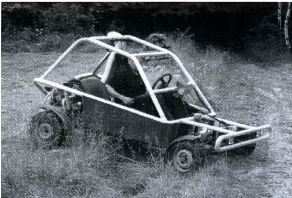
Rys. 19. Pojazd terenowy zbudowany na bazie Fiata 126p przez studentów w ramach pracy dyplomowej
