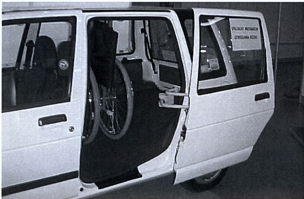
Rys. 17. Specjalny mechanizm otwierania drzwi samochodu inwalidzkiego. Konstrukcja uzyskała zastrzeżenie Urzędu Patentowego
