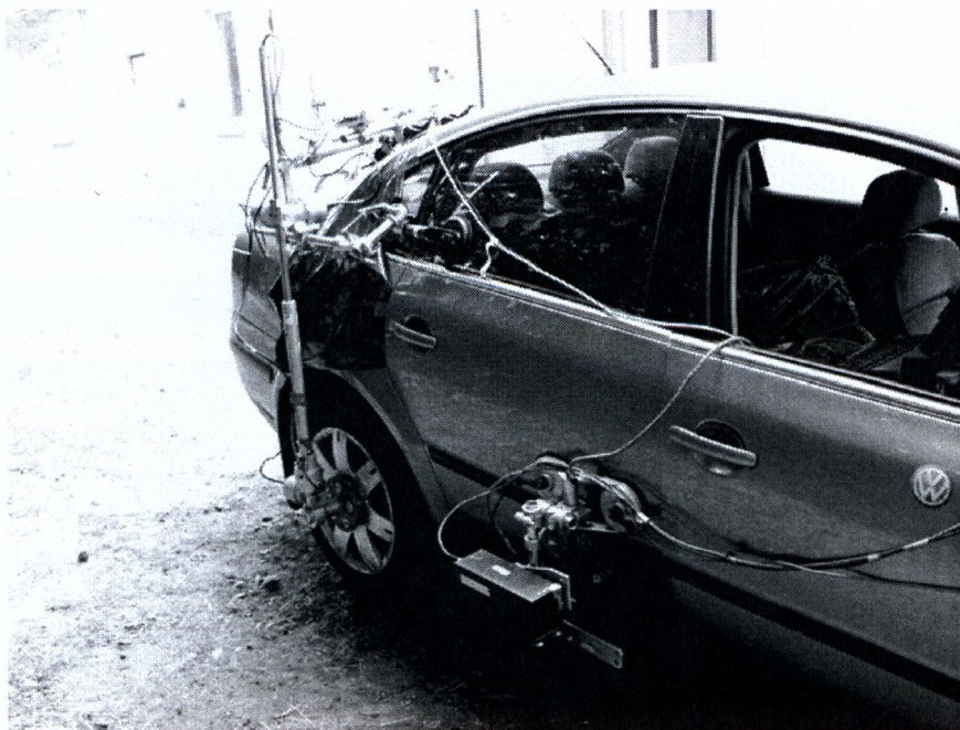
Rys. 26. Samochód wyposażony w aparaturę do badań drogowych – głowica Correvit i urządzenie RV3
