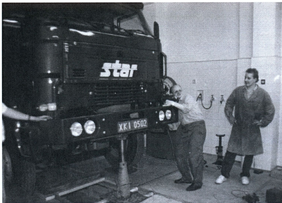
Rys. 15. Badanie drgań kół osi przedniej samochodu Star; od prawej Robert Janczur i Jacek Wojs
