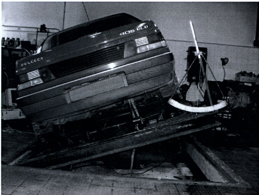
Rys. 25. Badania samochodu na stanowisku przechyłowym
