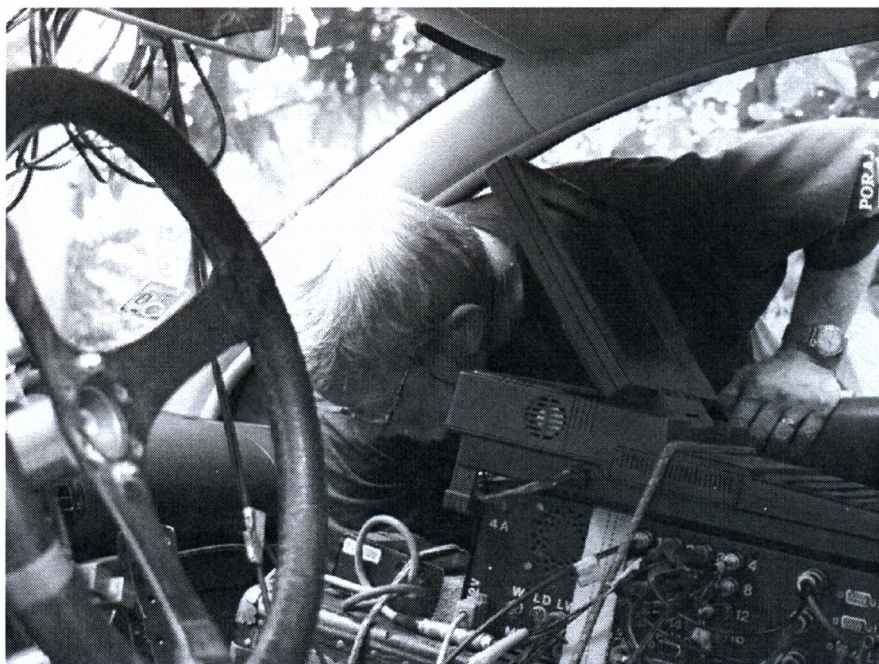
Rys. 27. Urządzenia przetwarzające i rejestrujące badane parametry – wewnątrz samochodu
