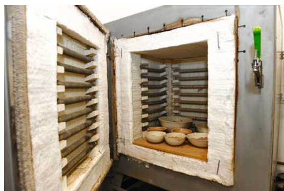
Łupki węglowe po wygrzewaniu w piecu (proces kalcynacji zmielonych łupków węglowych wykonywany w celu aktywacji materiału). Fot.: Jan Zych
