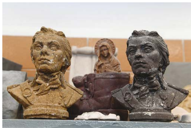
Swoboda formowania wyrobów ze spienionych geopolimerów pozwala na wykonywanie bardzo skomplikowanych kształtów. Fot.: Jan Zych
