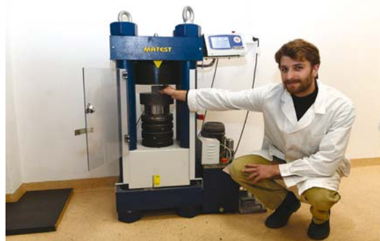
Badanie wytrzymałości próbki geopolimeru na ściskanie. Fot.: Jan Zych
