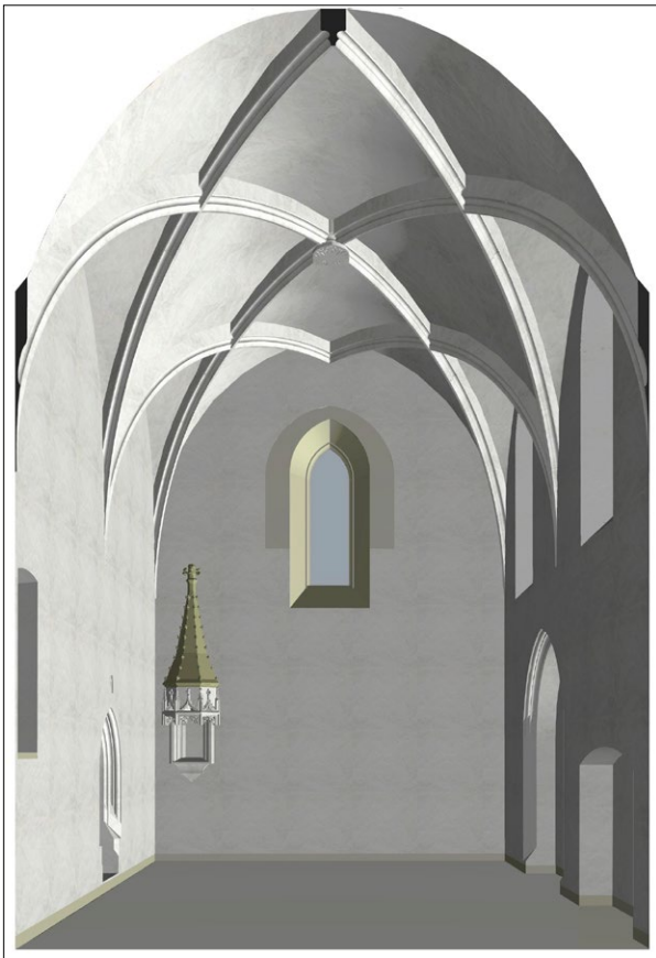
Ryc. 7. Kościół św. Bartłomieja Apostoła, prezbiterium z rekonstrukcją okna, zwieńczenia sakramentarium i pierwotnego poziomu posadzki.
