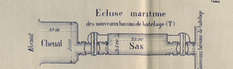
CARTE FIGURANT LES DIMENSIONS ET LA FORME DES PRINCIPALES ÉCLUSES DES VOIES NAVIGABLES DE LA BELGIQUE.
