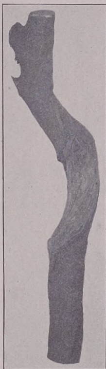
Bild 57. Hülsendorn mit Drehwuchs und Ringfäule. Querschnitt s. in Bild 45 e, S. 153.
