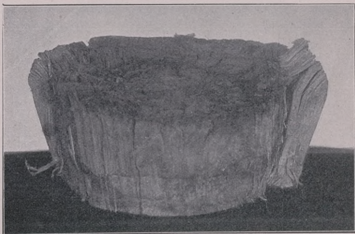
Bild 48 c. Hickory-Rammklotz (als Futter für einen schwer einzutreibenden Eisenbetonpfahl benutzt).
