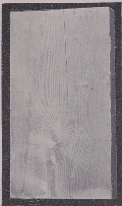
Bild 66 a. Vorderseite des Mittelstückes der Bohle Bild 29 mit einem eingewachsenen Aste, der erst nach dem Abhobeln hervortrat.
