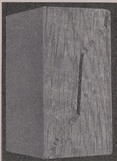
Bild 52 c. Ein Bongosiprisma zerdrückt. Seitenflächen mit Sprengköpfen 94) und Spaltbildung. Fast nat. GröÙe.
