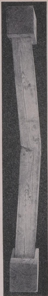
Bild 62 a. \frac{b}{h} = \frac{11,5}{129} = \frac{1}{11,2} . Bild 62 b. \frac{b}{h} = \frac{11,5}{135,3} = \frac{1}{11,7} .
