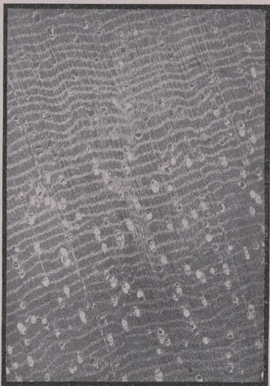
Bild 52 a. Bongosi-Hirnschnitt . V. 6,5/1. Oben Splint, unten Kern.
