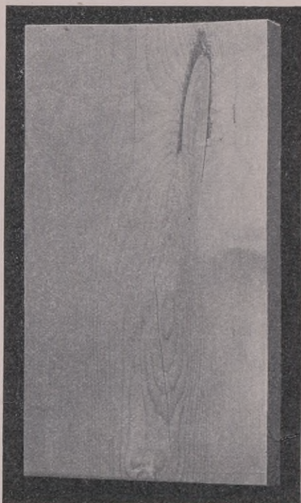
Bild 66 b. Rückseite des Mittelstückes der Bohle Bild 29 mit einem eingewachsenen Aste, der erst bei kräftigem Abhobeln hervortrat.
