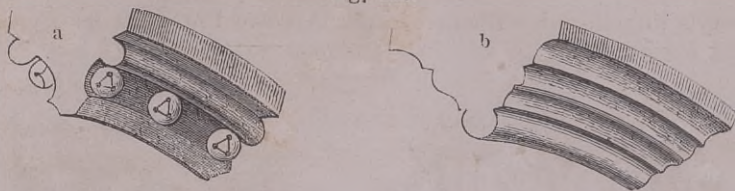
Gewölbrinnenprofile des Perpendicularstyls, a von der Kathedrale in Gloucester, b von der Divinity-School in Oxford.
