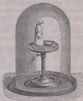
Fig. 77. Wasseranziehung durch Schwefelsäure.
