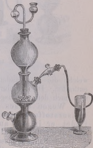
Fig. 226. Einwirkung von Schwefelwasserstoff auf Salzlösungen.
