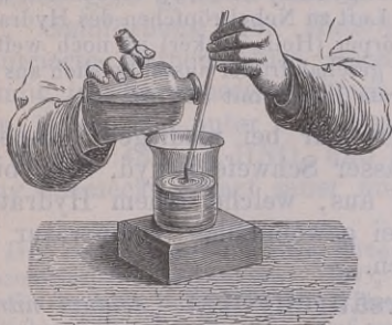
Fig. 76. Mischen von Schwefelsäurehydrat mit Wasser.
