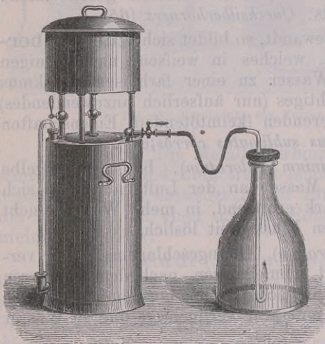
Fig. 49. Verbrennung von Wasserstoff in Chlor.
