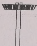
Fig. 40. Ungenügend geschliffenes Ventil.
