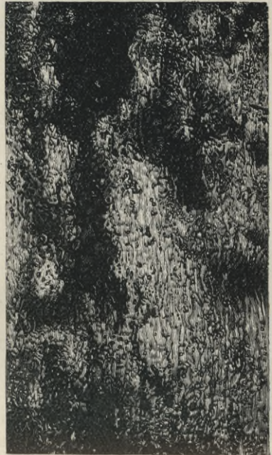
Faserstruktur des Meereises bei einem Schnitt senkrecht gegen die Oberfläche. Bei L Luftblasen. Die Kornstruktur ist aus dem helleren und dunkleren Schatten erkennbar.
