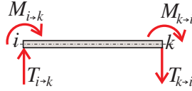
Rysunek 6.3. Zwroty uogólnionych sił przywęzłowych dla pręta obustronnie zamocowanego sprężysto.
