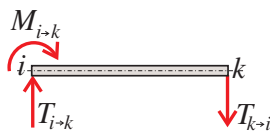
Rysunek 6.5. Zwroty uogólnionych sił przywęzłowych dla pręta jednym końcem przegubowo podpartego.
