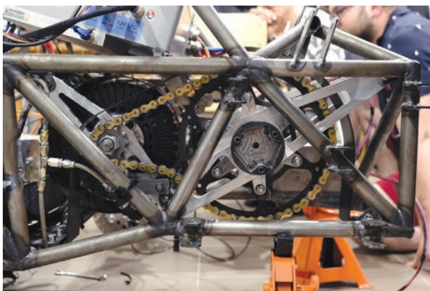
Napęd tylnych kół pochodzi z dwóch silników elektrycznych współpracujących z łańcuchowymi przekładniami głównymi. Fot.: Jakub Smoczyński
