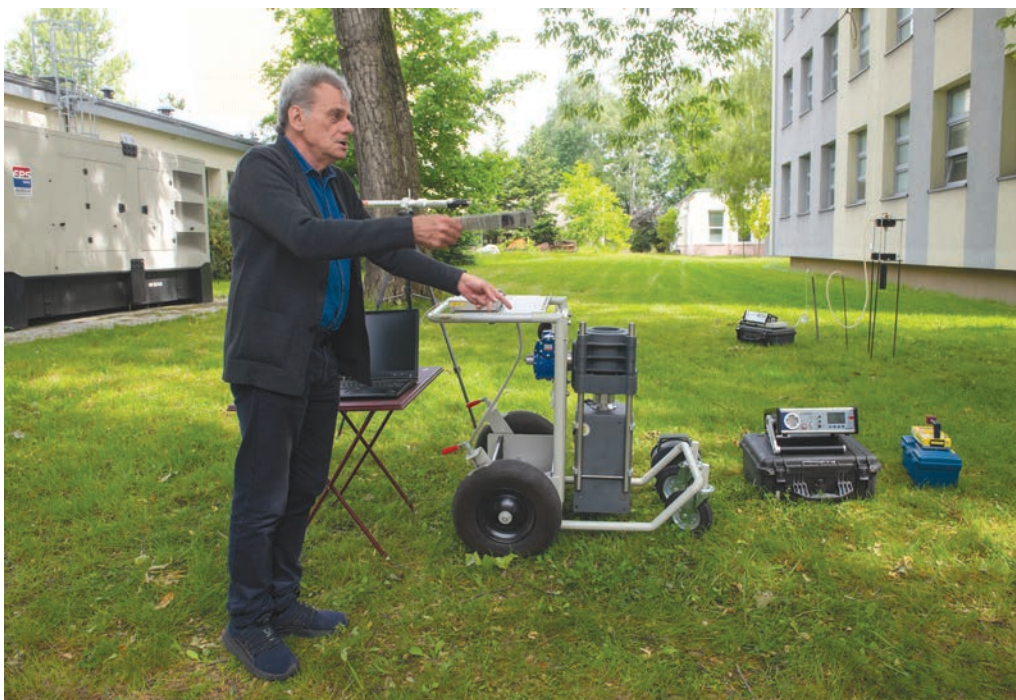
Wyposażenie IFJ, służące do pomiarów stężeń radonu oraz do wyznaczania widma promieniowania gamma (identyfikacji nuklidów promieniotwórczych) w środowisku — prezentuje Krzysztof Kozak
