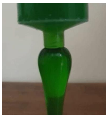
Rys.5.14. Efekt Barusa podczas wypływu płynu sprężystolepkiego z przewodu [130]
