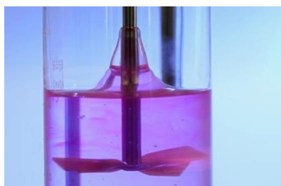
Rys.5.15. Efekt Weissenberga podczas mieszania płynu sprężystolepkiego w mieszalniku [130]
