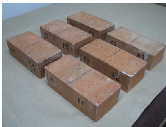
Rys. 5.1 Przykłady cegieł wykorzystanych w badaniach własnych: a) cegła b1 – palcówka, b) cegły b2 – saskie, c) cegły b3 – lata 70-te XIX wieku, d) cegły b4 – ostatnia dekada XIX wieku, e) cegły b5 – ostatnia dekada XIX wieku, f) cegły b6 – przełom XIX i XX wieku, g) cegła b7 – przełom XIX i XX wieku, h) cegły b8 – produkowane współcześnie
