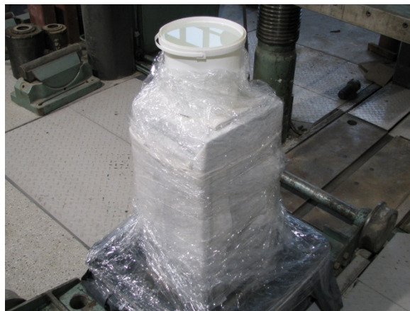
Rys. 6.4 Sezonowanie murów do stanu „mokrego”: a) etap nr 1 (kapilarne podciąganie), b) etap nr 2 – nasycenie muru wodą przez mokre maty bawełniane
