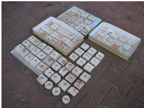
Rys. 5.21 Etapy przygotowania prostokątnych próbek zapraw historycznych do badań:
