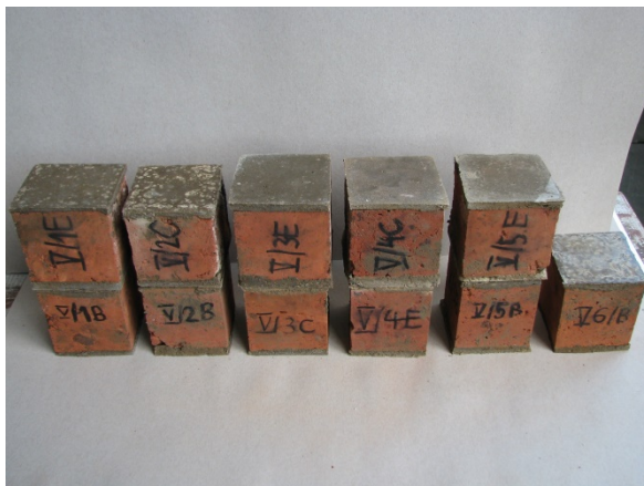
Rys. 5.2 Przykłady elementów przygotowanych do badań wytrzymałościowych cegieł: a) walce (odwierty) \varnothing 50\text{mm} , h=50\text{mm} – cegły b1, b) kostki 60mm – cegły b3, c) półówki cegieł – cegły b4
