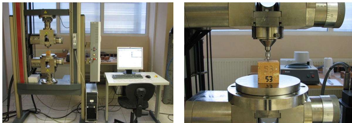
Rys. 5.20 Maszyna wytrzymałościowa ZWICK/ROELL Z100 przygotowana do badania twardości powierzchniowej cegieł.
