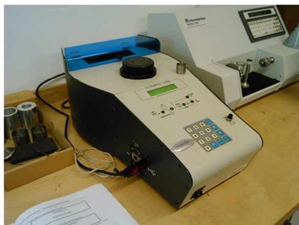
Rys. 5.5 Piknometr helowy Quantachrome Ultrapyc 1200e do oceny porowatości cegieł ceramicznych
