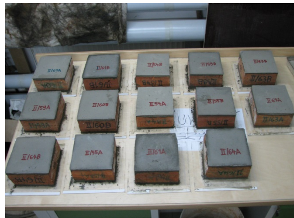
Rys. 5.2 Przykłady elementów przygotowanych do badań wytrzymałościowych cegieł: a) walce (odwierty) \varnothing 50\text{mm} , h=50\text{mm} – cegły b1, b) kostki 60mm – cegły b3, c) półówki cegieł – cegły b4
