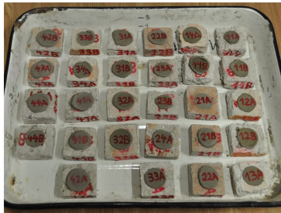
Rys. 5.21 Etapy przygotowania prostokątnych próbek zapraw historycznych do badań:
