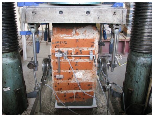
Rys. 6.6 Widok filara F1/2 na stanowisku badawczym
