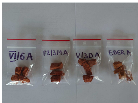
Rys. 5.7 Widok elementów wyciętych z cegieł i przygotowanych do badań w porozymetrze rtęciowym
