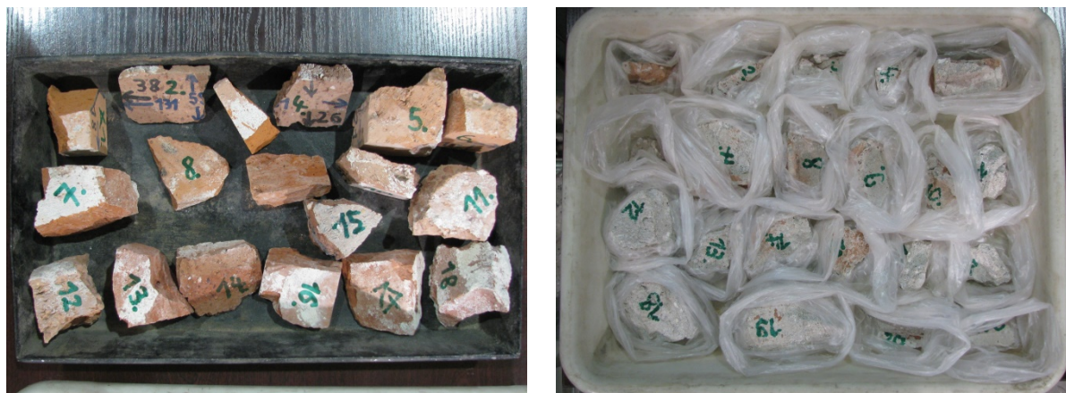
Rys. 6.7 Fragmenty cegieł i zapraw pobrane z filara do oceny stopnia wilgotności muru
