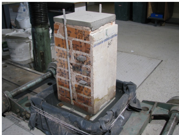
Rys. 6.4 Sezonowanie murów do stanu „mokrego”: a) etap nr 1 (kapilarne podciąganie), b) etap nr 2 – nasycenie muru wodą przez mokre maty bawełniane
