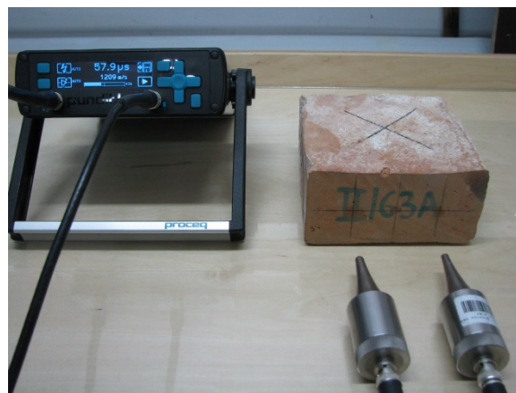
Rys. 5.17 Stanowisko do badań ultradźwiękowych
