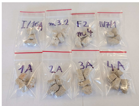
Rys. 5.27 Widok próbek zapraw przygotowanych do badań w porozymetrze rtęciowym – ocena struktury porów
