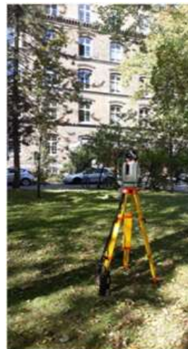
il. 81. Skanowanie skanerem laserowym Riegl VZ-400 drzew iglastych i drzew liściastych. [Opracowanie własne]
