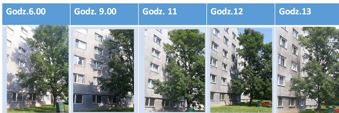
il.43. Efekt współczynnika przezierności drzewa dla elewacji wschodniej w zależności od azymutu Słońca, okres lata. [Opracowanie własne]
