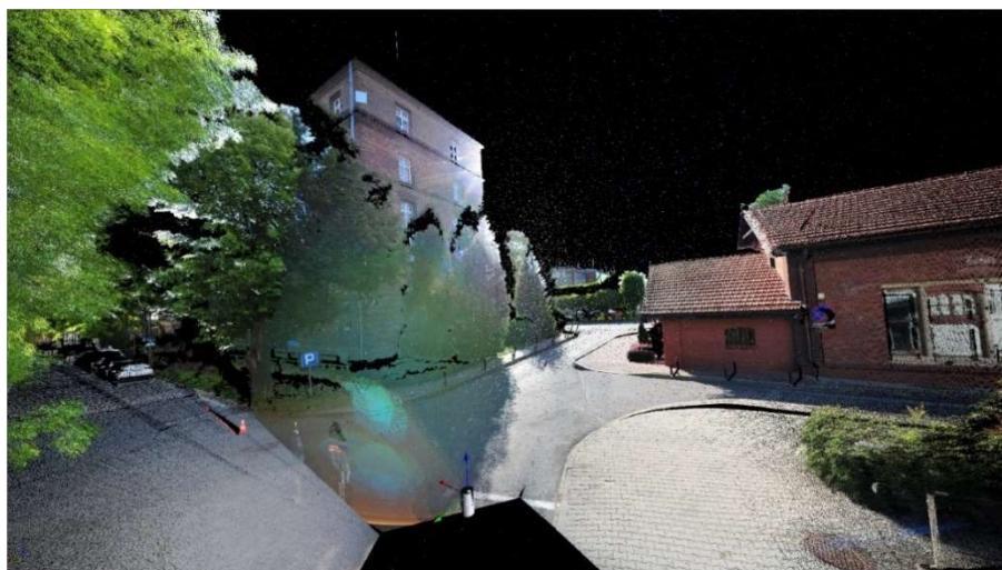
il. 84. Połączone skany nałożone na fotografię (skorelowaną w czasie ze skanowaniem).[Opracowanie własne]
