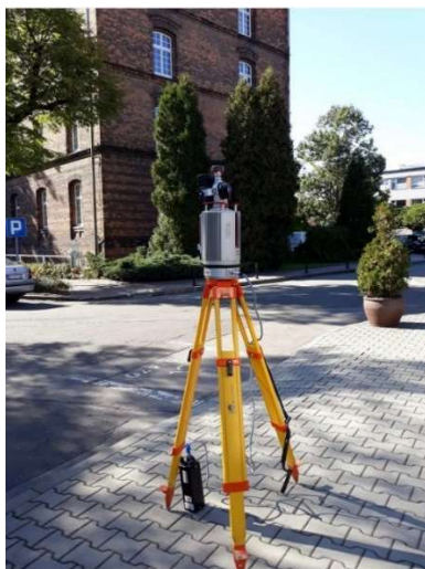
il. 81. Skanowanie skanerem laserowym Riegl VZ-400 drzew iglastych i drzew liściastych. [Opracowanie własne]
