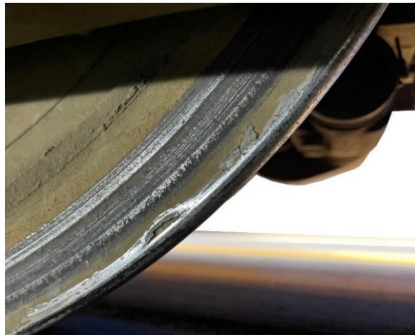
Rys. 2.27. Przykład zużycia powstałego na wewnętrznej części obrzeża koła tramwajowego [źródło własne]
