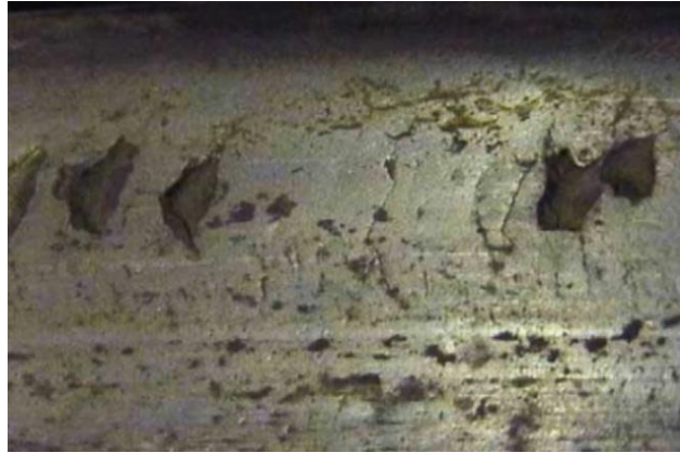
Rys. 2.29. Przykład zużycia zmęczeniowego typu spalling na płaszczyźnie tocznej koła [65]
