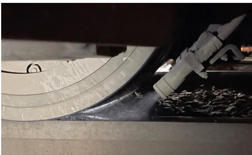
Rys. 2.25. Lokalizacja zabudowy dyszy piasecznicy w wagonie tramwajowym [źródło własne]
