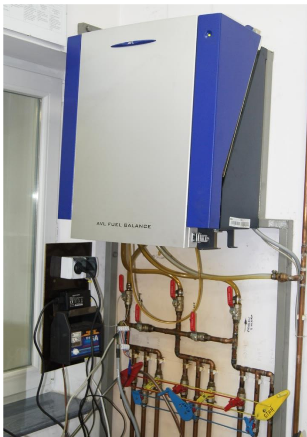
Rysunek 5.2. Widok ogólny masowej, dynamicznej miernicy zużycia paliwa AVL Fuel Balance
