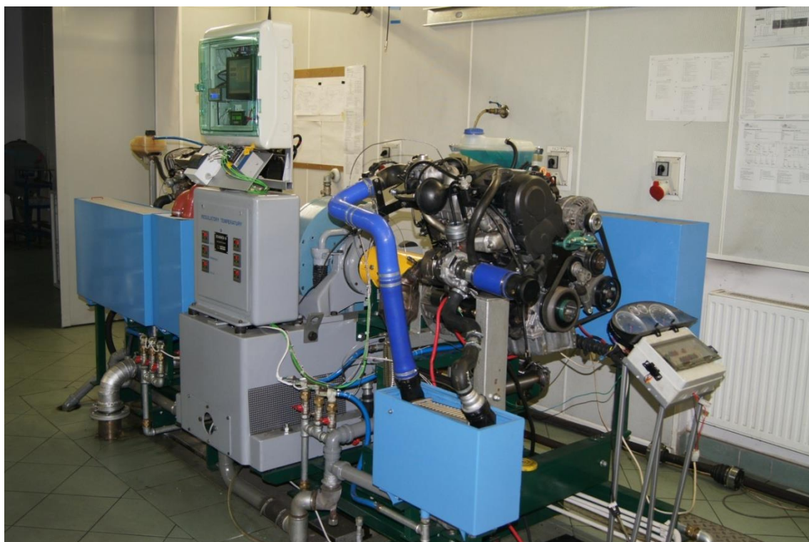
Rysunek 7.1. Widok ogólny hamownianego stanowiska badawczego z elektrowirowym hamulcem Schenck i silnikiem ZS
