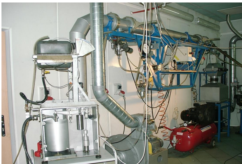
Rysunek 5.5. Widok ogólny stanowiska pomiarowego z tunelem rozcieńczającym spaliny do określania emisji cząstek stałych PM
