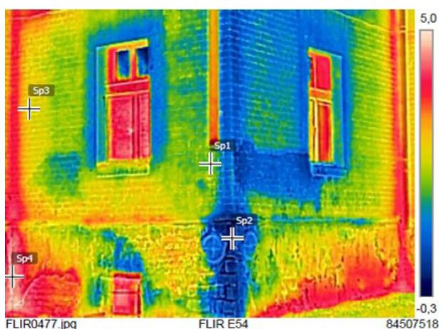
II. 18. Badanie termowizyjne fasad familoków w Bytomiu, Bobrku – narożnik typowego budynku. Lokalne wychłodzenie w miejscu większej ilości elementów metalowych (dobrze przewodzących ciepło), elementy metalowe przyjmują temperaturę otoczenia. Fot. M. Krause-Świerczyńska, 01.2023
