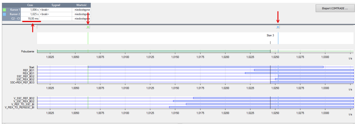
Rys. 127. Wykres pomiarów sygnałów GOOSE dla topologii struktury zasilająco-sterującej – scenariusz pierwszy próba pierwsza [opracowanie własne]
