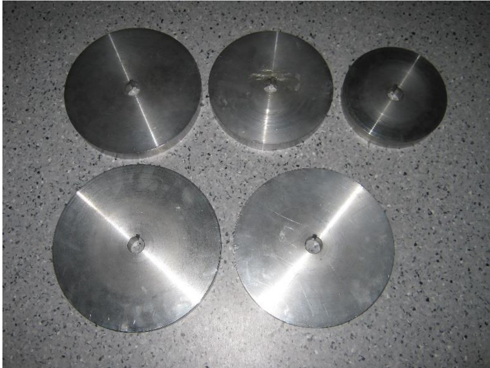
Rys. 4.5. Zestaw dodatkowych kół umożliwiających uzyskanie zwiększenia momentów bezwładności.
