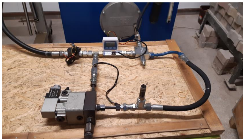
Rys. .74. Widok układu badawczego: 1 – badany regulator, 2 – przetworniki ciśnienia, 3- przepływomierze, 4-generator obciążenia.
