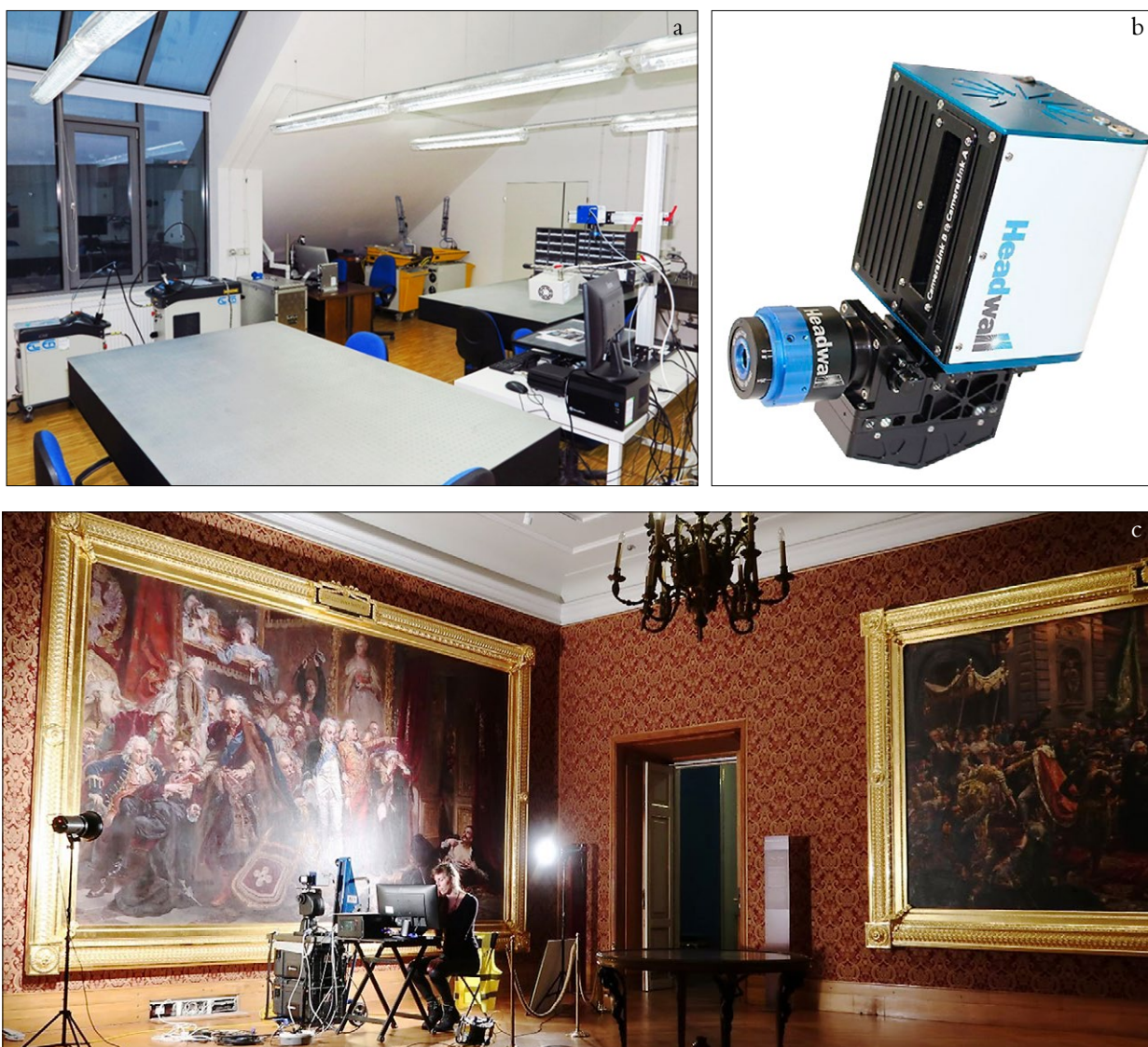
Ryc. 1. Stanowisko badawcze do badań HSI w laboratorium Pogotowia Konserwatorskiego w Warszawie [a] i w trakcie sesji pomiarowej in situ w pomieszczeniach ekspozycyjnych Muzeum Zamek Królewski w Warszawie [c] wraz z modelem kamery hiperspektralnej będącej na wyposażeniu PK [b]; [a, c] fot. P. Zambrzycki, [b] karta techniczna produktu [Hyperspectral at Scale].
