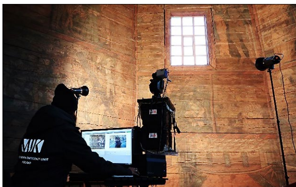
Ryc. 3. Przykładowe stanowisko badawcze HSI w trakcie sesji terenowej [a] wraz ze schematem elementów składowych aparatury [b]; [a] fot. P. Zambrzycki, [b] [Introduction to Infrared Reflectography].
