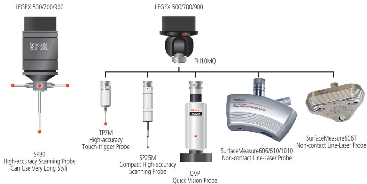
Rysunek 2.6. Rodzaje głowic możliwych do zastosowania w maszynach serii LEGEX [W3]
