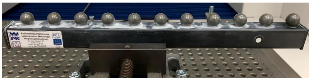
Rysunek 9.24. Wzorzec typu ball-bar wykorzystywany do pomiarów optycznych
