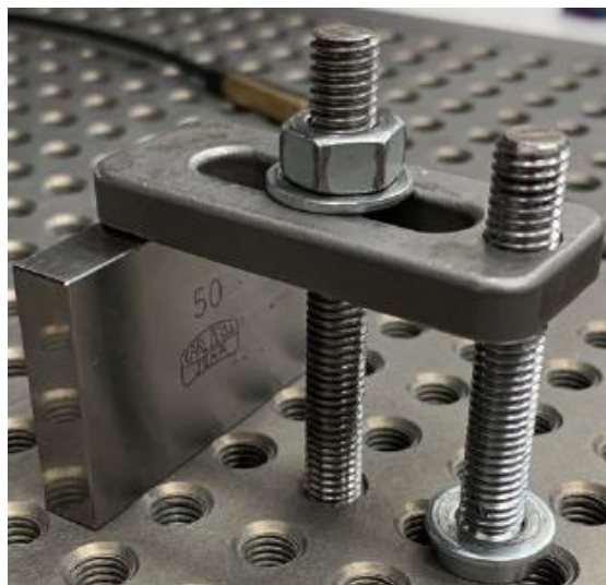
Rysunek 9.3. Poglądowy sposób zamocowania płytki wzorcowej do pomiaru
