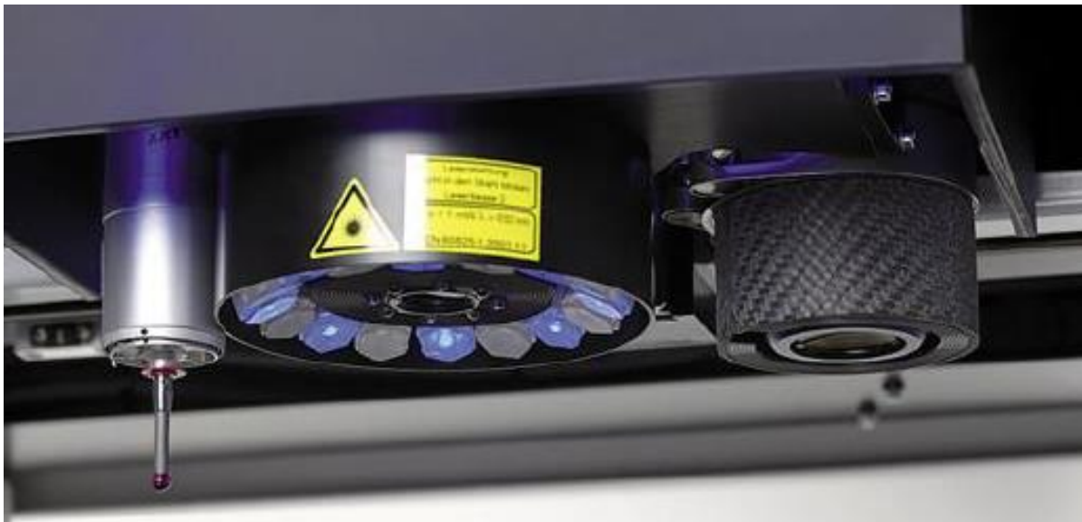
Rysunek 2.2. Od lewej głowica stykowa VAST XXT, głowica optyczna Discovery.V12, interferometr światła białego DotScan [30]
