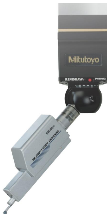
Rysunek 2.7. Sonda SurfTest firmy Mitutoyo przeznaczona do pomiarów chropowatości powierzchni [W3]
