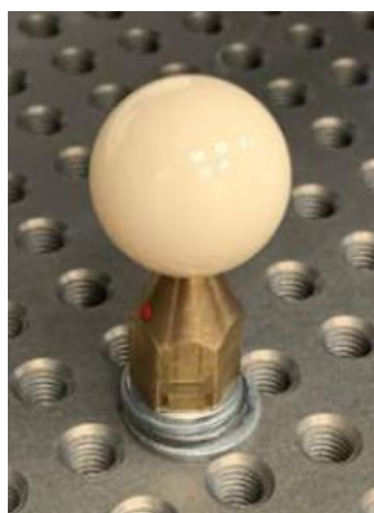
Rysunek 9.1. Kula referencyjna o nr seryjnym K0564 użyta do wzorcowania systemu stykowego
