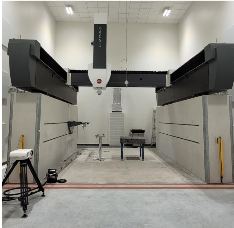
Rysunek 1.2. Maszyna Leitz PMM-G – konstrukcja zamknięta
