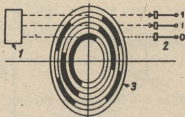
Rys.IV-8a. Zasada działania czujnika mechaniczno-optycznego do pomiaru przemieszczeń kątowych: 1 - źródło światła, 2 - fotoelementy, 3 - tarcza kodująca
