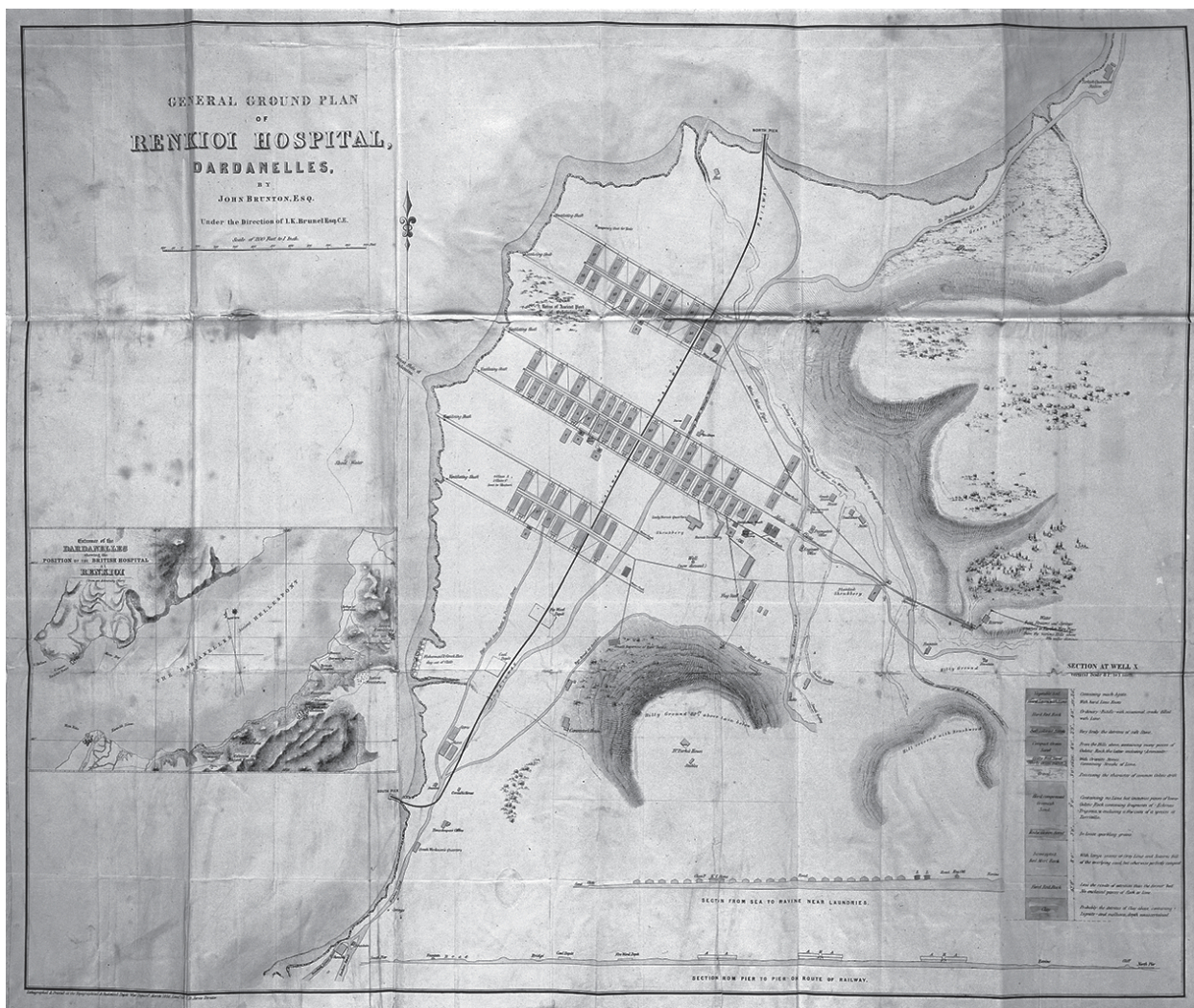
II. 1. Mapa autorstwa Johna Bruntona przedstawiająca układ innowacyjnego prefabrykowanego szpitala Renkioi zaprojektowanego przez Isambarda Kingdoma Brunela. https://www.worldhistory.org/image/17230/map-of-renkioi-hospital/ (dostęp: 30.10.2024)
