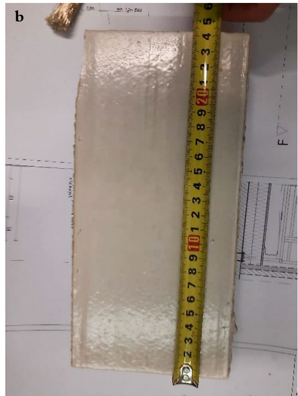
Ryc. 7. Płytką elewacyjną typu „Przyborsk”: a) po demontażu, b) po oczyszczeniu, 2023; fot. P. Marciniak Fig. 7. “Przyborsk” facade tile: a) after removal, b) after cleaning, 2023; photo by P. Marciniak
