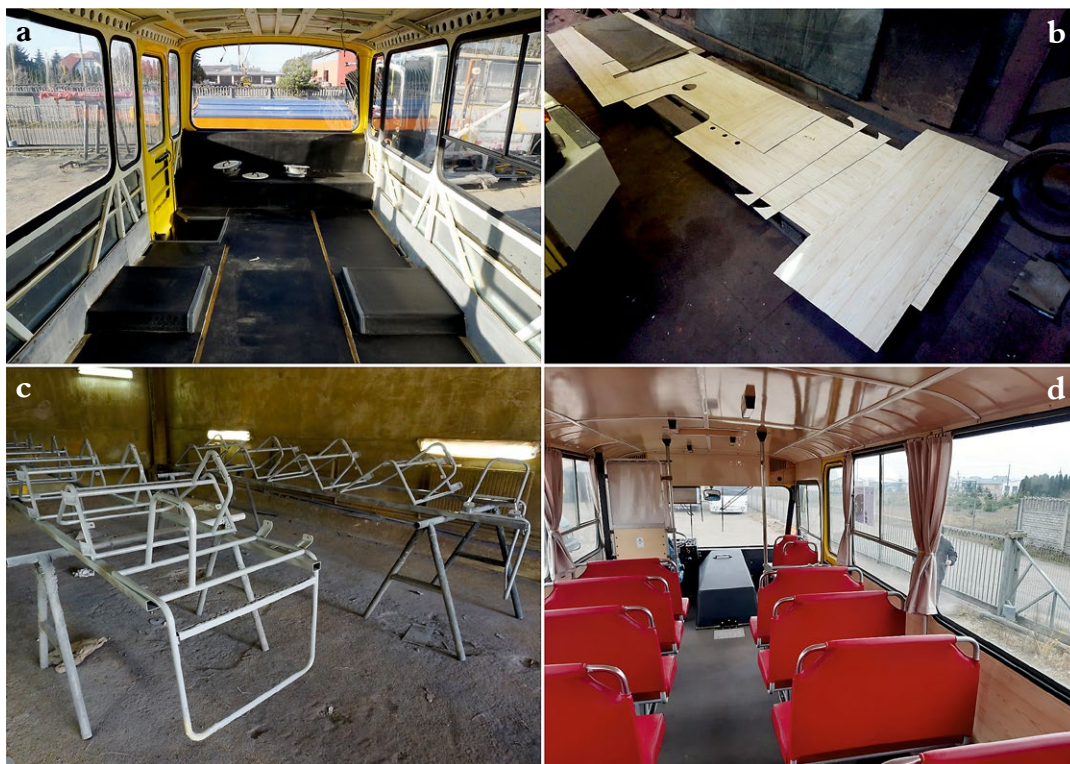
Ryc. 7. Trzeci etap remontu autobusu: a) puste wnętrze autobusu przed rozpoczęciem prac w ramach tego etapu, b) wykrojone płyty wyścielenia ścian i sufitu (na zdjęciu repliki, które zastąpiły płyty nienadające się do powtórniego wykorzystania), c) stelaże foteli podczas malowania, d) wnętrze po zakończeniu prac; fot. K. Kołodziejczyk
