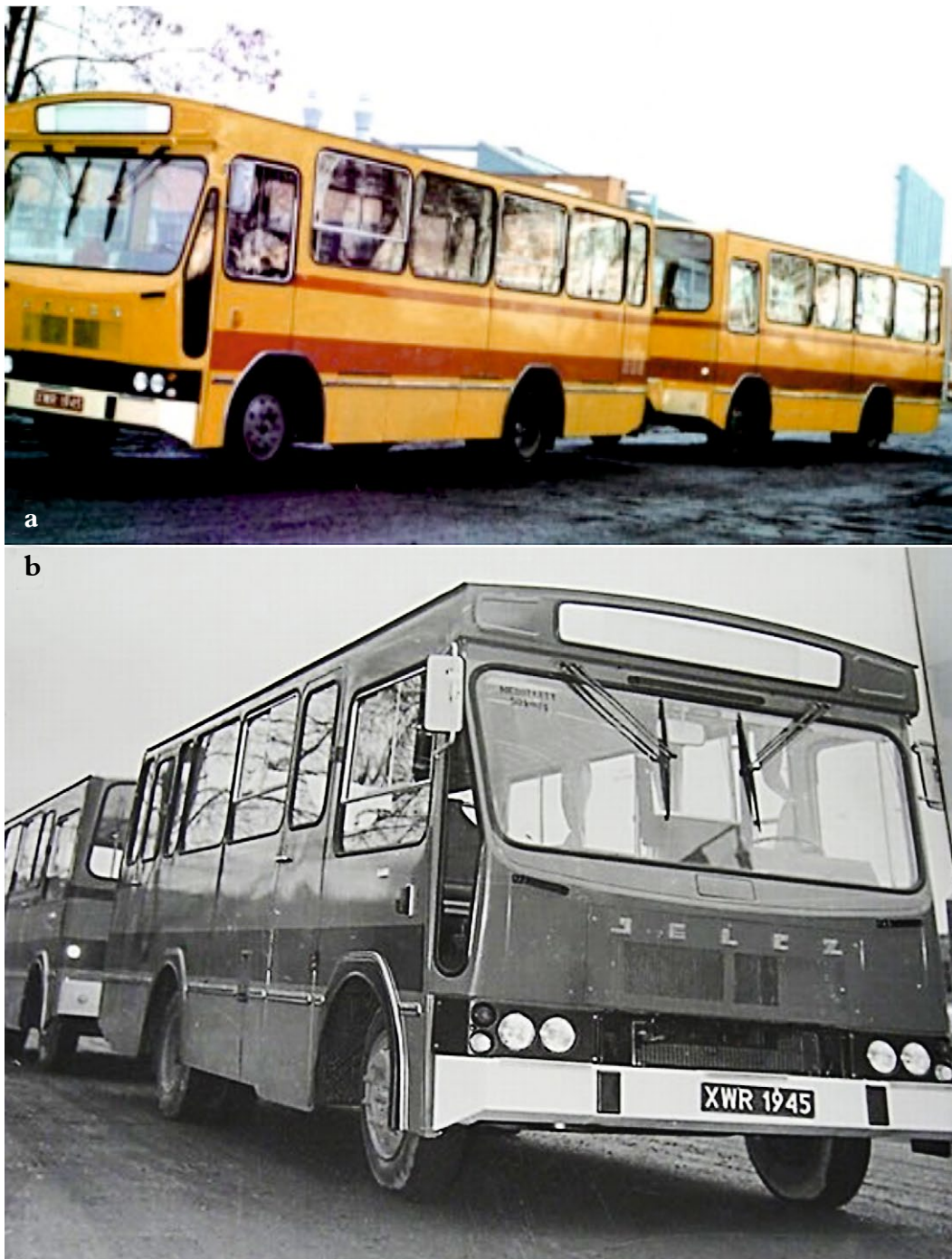
Ryc. 1. Nieliczne zdjęcia oryginalnego zespołu pojazdów, złożonego z prototypowego autobusu Jelcz 080 oraz przyczepy Jelcz P-080: a) fotografia z 1980 r. przedstawiająca wygląd fabryczny i oryginalną kolorystykę obu pojazdów, czyli docelowy wygląd zespołu po remoncie; b) zespół pojazdów podczas testów we Wrocławiu ok. 1980 r.; źródło: archiwum Klubu Sympatyków Transportu Miejskiego
