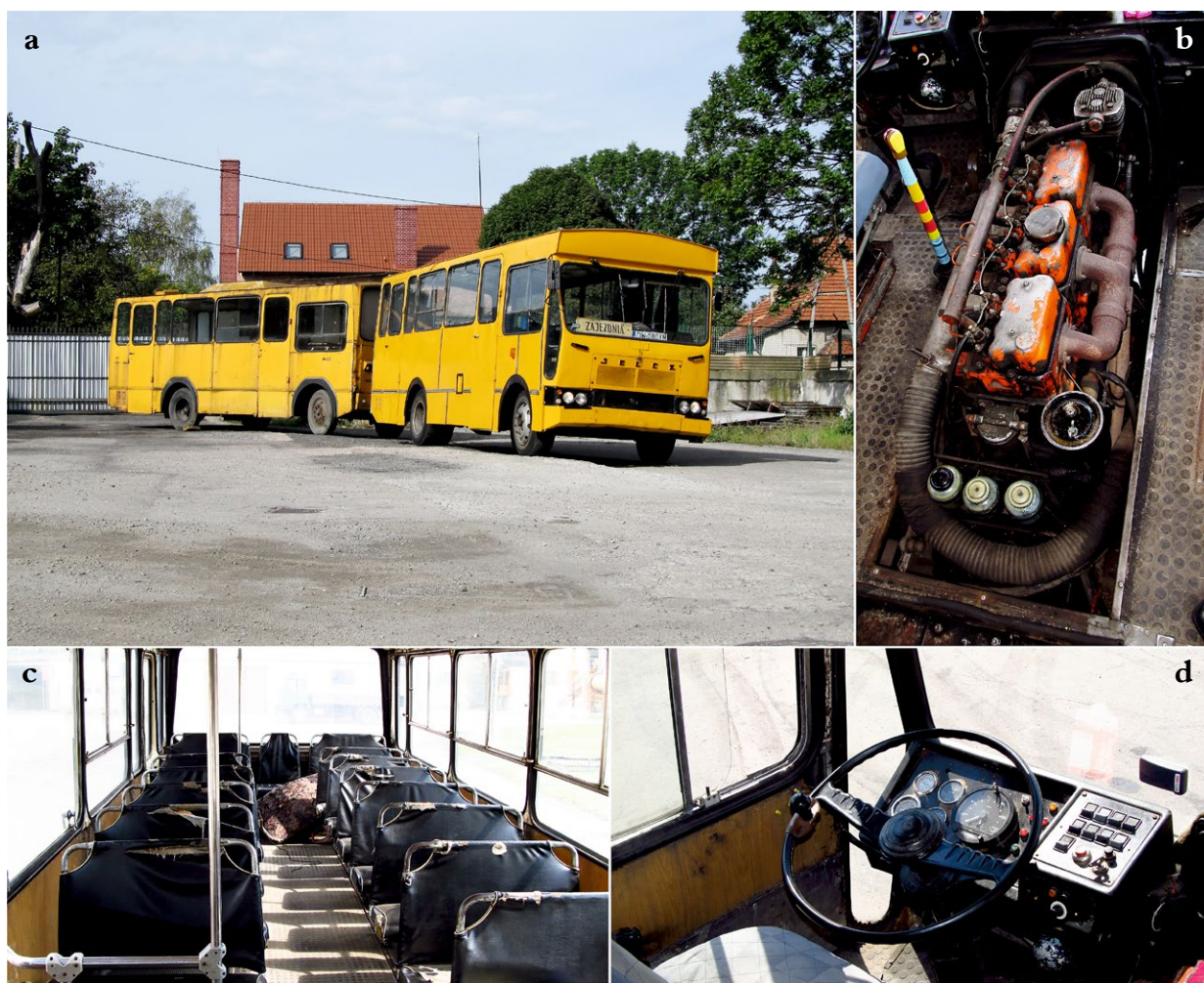
Ryc. 2. Stan autobusu Jelcz 080 przed remontem: a) autobus wraz z przyczepą, b) silnik, c) ogólny widok wnętrza (zwracają uwagę podarte poszycia siedzeń), d) stanowisko kierowcy (widoczne m.in. zniszczone wyścielenie ściany); fot. A. Zylbertal
