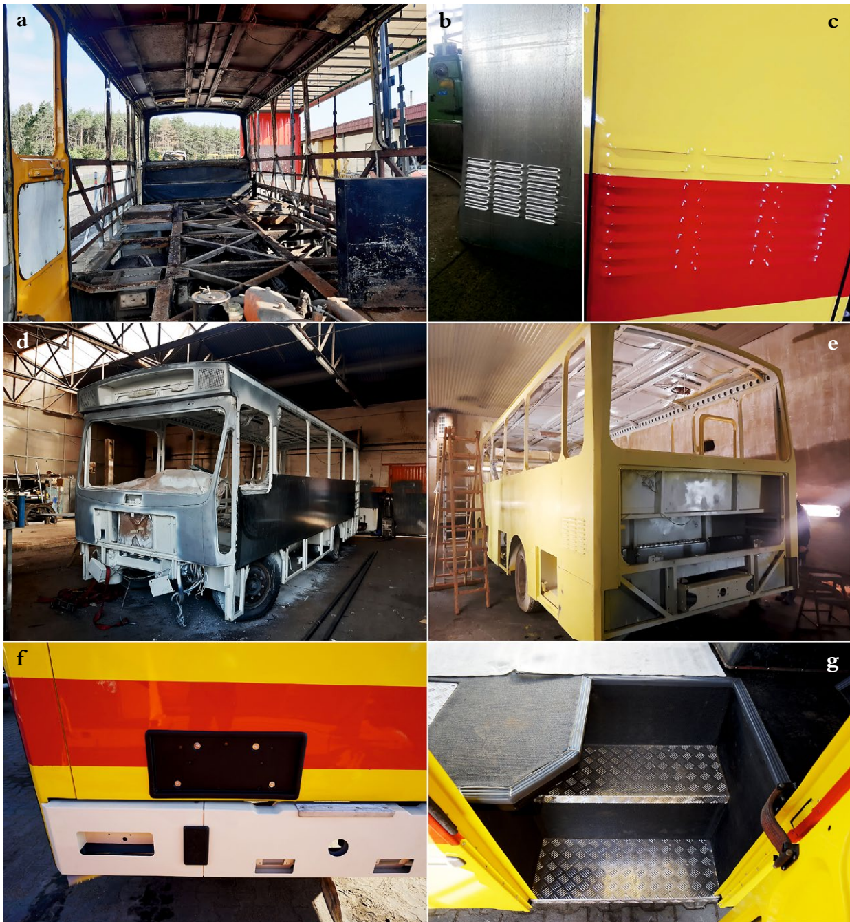
Ryc. 5. Pierwszy etap remontu autobusu: a) konstrukcja z licznymi ogniskami korozji po demontażu wnętrza i większości podzespołów, b–c) wykonany jednostkowo element oblachowania (wlot powietrza do pieca ogrzewczego w tylnej części lewej burty) przed i po lakierowaniu, d) autobus po wymianie skorodowanych elementów konstrukcyjnych, na początku kładzenia oblachowania, e) autobus po wykonaniu blacharki i położeniu podkładowej warstwy malarskiej, f) fragment ściany tylnej po zakończeniu prac przewidzianych w pierwszym etapie, po prawej w zderzaku miejsce do umieszczenia zaczepu, g) schody wejściowe wykończone blachą aluminiową na stopniach i gumowymi listwami na krawędziach podłogi; fot. K. Kołodziejczyk (b, c, f, g), K. Wasilewski (a, d, e)
