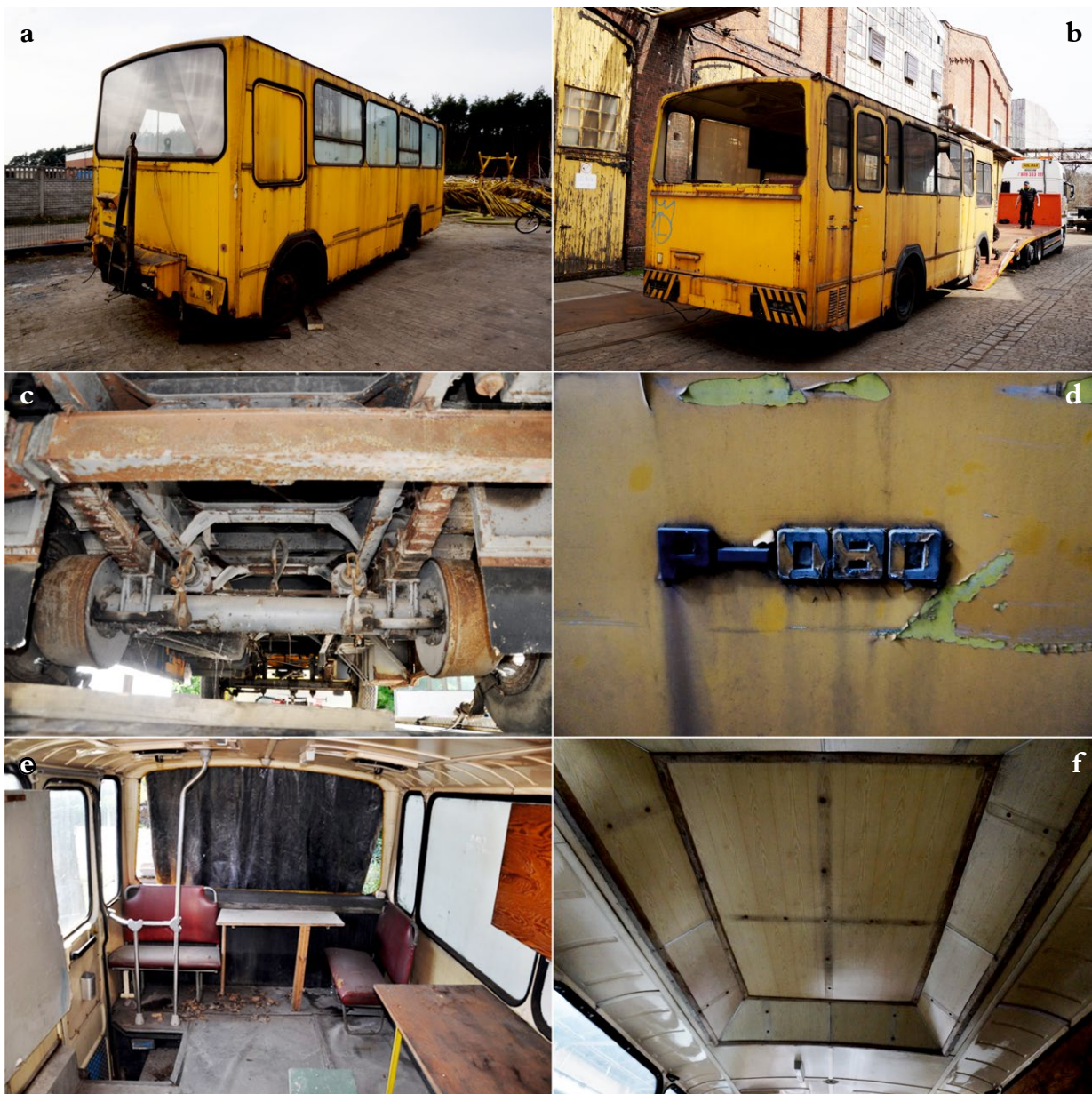
Ryc. 3. Stan przyczepy Jelcz P-080 przed remontem: a) widok od przodu z dyszlem służącym do połączenia z autobusem, b) widok od tyłu (załadunek na lawetę w celu transportu do zakładu remontowego), c) widok na ramę i mechanizmy podwozia w tylnej części przyczepy, d) oznaczenie typu, e) wnętrze (ponieważ przyczepa została przebudowana na mobilny ambulans RTG, a potem na potrzeby zaplecza socjalnego na budowie, układ wnętrza nie był oryginalny), f) fragment sufitu z nadbudówką, która powstała, by zmieścić w środku przyczepy aparat RTG; fot. K. Kołodziejczyk (b, d, f), K. Wasilewski (a), A. Zylbertal (c, e)
