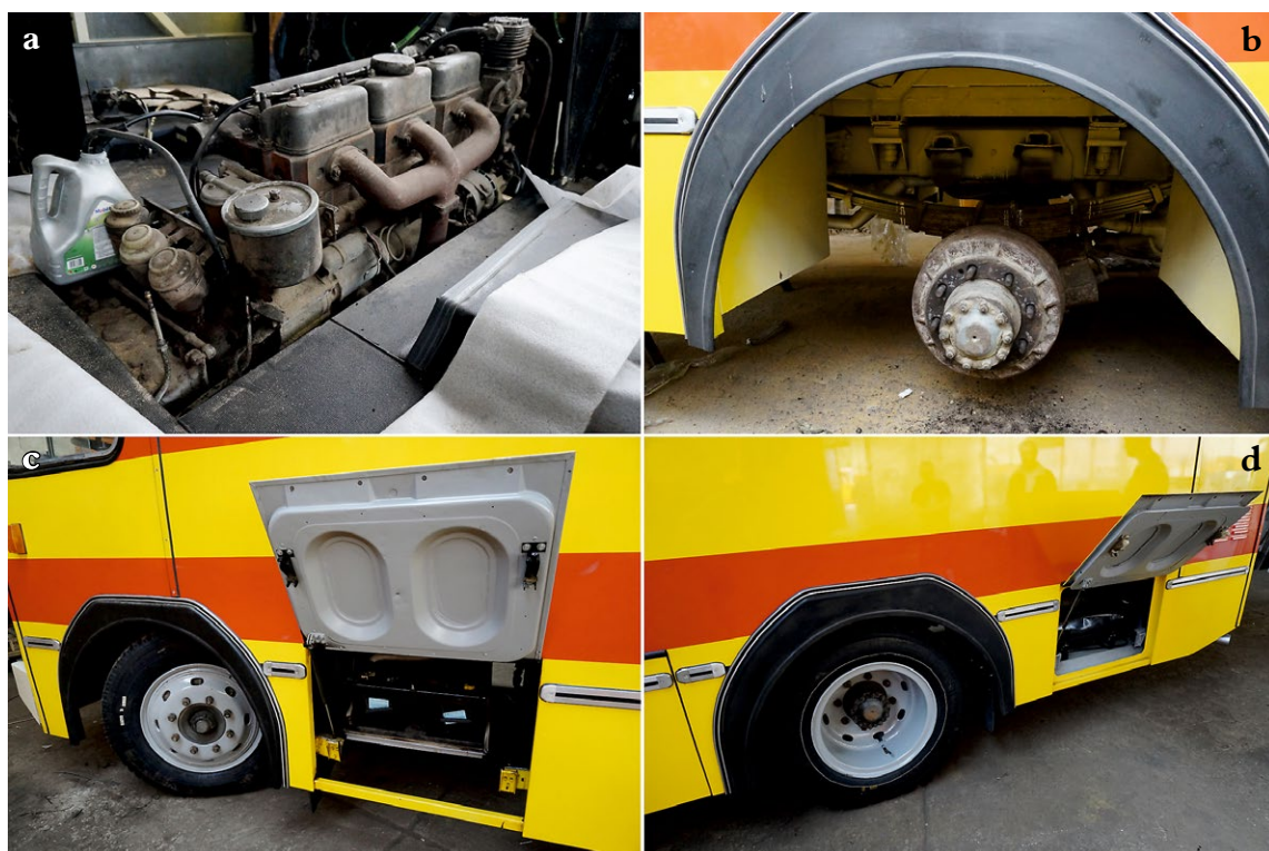
Ryc. 6. Drugi etap remontu autobusu: a) silnik po oczyszczeniu z wycieków płynów eksploatacyjnych, w trakcie sprawdzania stanu technicznego, b) zdjęte koła podczas przeglądu tylnej osi, c) nowe akumulatory, d) tylna oś po regeneracji oraz otwarty luk z piecem odpowiedzialnym za ogrzewanie pojazdu; fot. K. Kołodziejczyk
