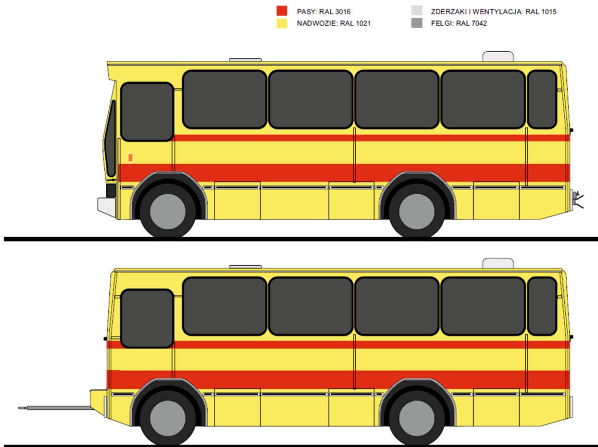
Ryc. 4. Projekt malowania zespołu pojazdów Jelcz 080 i Jelcz P-080 Fig. 4. Painting project for the Jelcz 080 and Jelcz P-080 vehicle set
