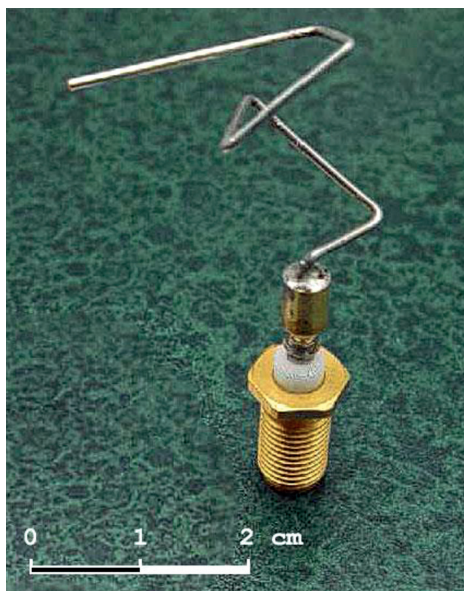
Il. 1. Antena radiowa, której kształt został wygenerowany przez algorytm genetyczny (NASA, 2006)
