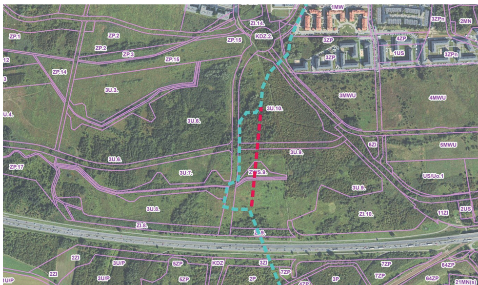
II. 11. Przebieg planowanej sieci gazowej w wariancie pierwotnym i po zmianach; kolorem czerwonym oznaczono pierwotnie planowaną trasę gazociągu, kolorem zielonym zmienioną trasę w układzie docelowym. Oprac. aut. na podst. (UMK, 2025)
