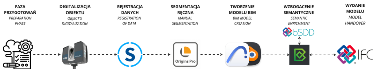
Ryc. 2. Proponowana ścieżka tworzenia modelu Heritage BIM w oparciu o skaning laserowy; proces bierze pod uwagę segmentację manualną chmury punktów obiektów ważnych w kontekście inwentaryzacji
