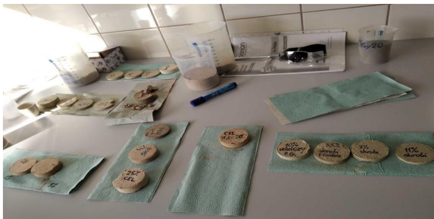
Rys. 8-3 Proces formowania krążków -podejście nr 1
