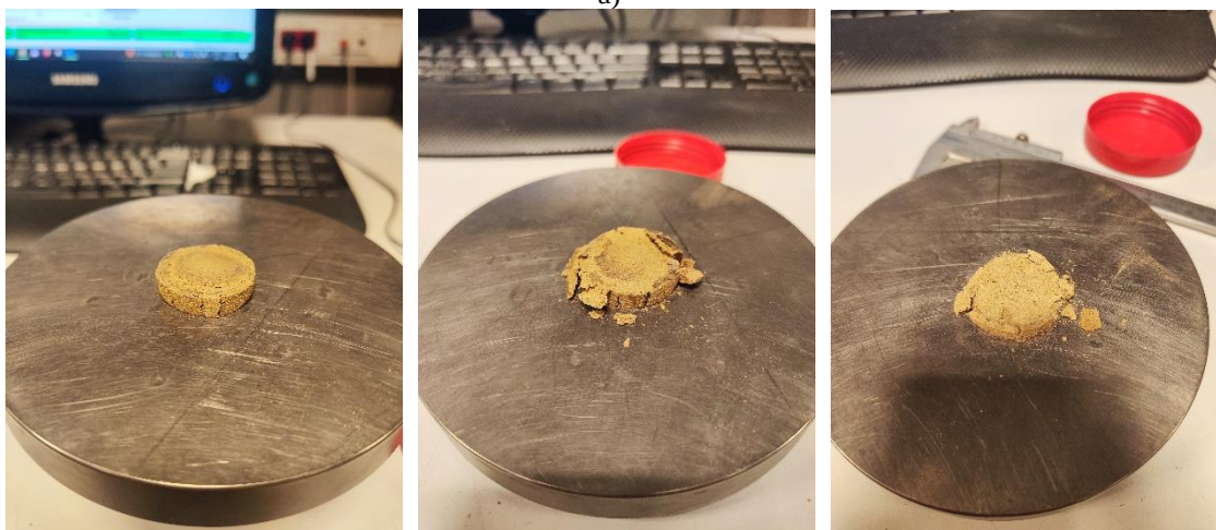
Rys. 8-8 Zdjęcia porównawcze a) pastylki nr 1 po próbie ściskania z pastylką nr 2 przed ściskaniem, b) pastylki nr 5, 7 i 9 (kolejno od lewej) z widoczną coraz silniejszą fragmentacją próbki
