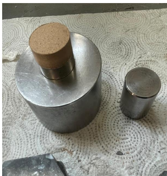
Rys. 8-4 Procedura formowania krążków – podejście nr 2 Źródło: Fotografie własne
