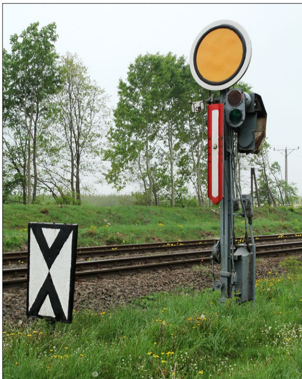
Ryc. 9. Jedyna w Polsce tarcza ostrzegawcza trzystawna o napędzie elektrycznym w Żarach; 2018, fot. M. Urbaniak
