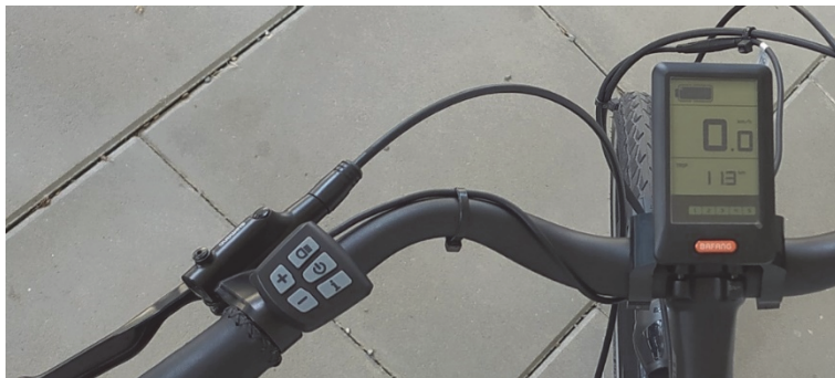
Ryc. 3. Elementy sterowania roweru Unibike Swift.
