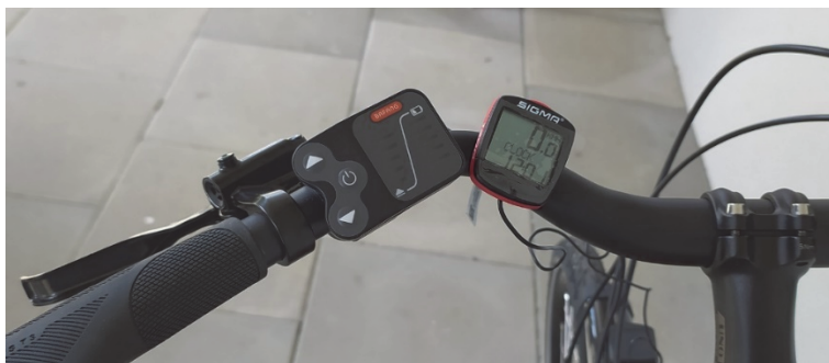
Ryc. 4. Elementy sterowania i dodatkowy licznik w rowerze Unibike Optima.
