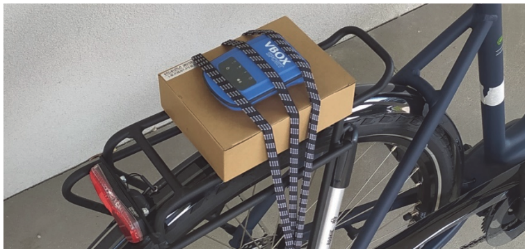
Ryc. 5. Urządzenie VBox Sport zamontowane na bagażniku roweru Unibike Swift.
