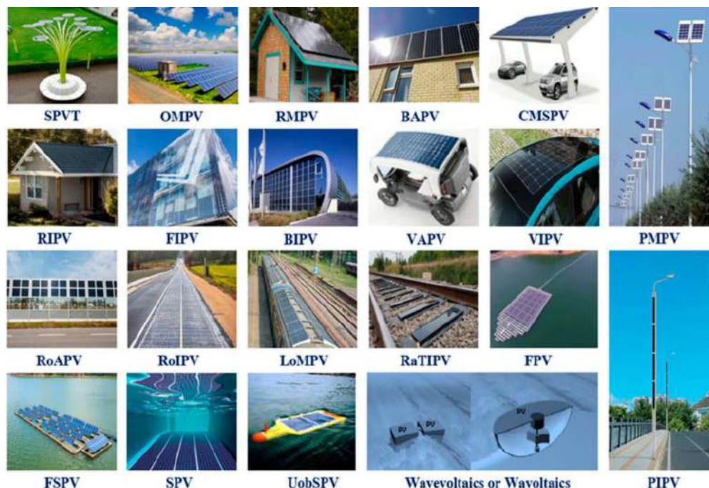
Il. 39. Podział instalacji PV ze względu na sposób montażu (źródło ilustracji wg. przypisu 100 )
