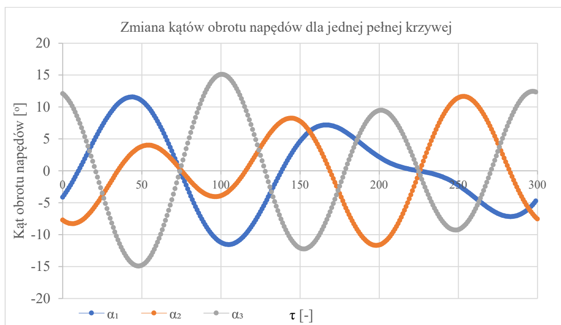
Rys.10.15. Zmiana kątów obrotu napędów dla trzech napędów manipulatora.
