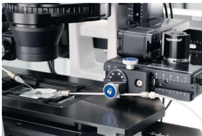
Rys.1.1. Konwencjonalny manipulator Eppendorf TransferMan 4m [1].
