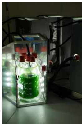
Il. 3. Fotobioreaktor Fraunhofer FEP do hodowli mikroorganizmów fototroficznych w skali laboratoryjnej w określonych warunkach oświetlenia, temperatury i gazów (©Fraunhofer FEP, 2024). Za zgodą U. König
