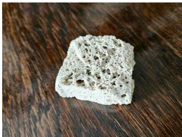
Il. 4. Zmineralizowany, stały kamień porowaty (©Fraunhofer IKTS, 2024). Za zgodą A. Ballin
