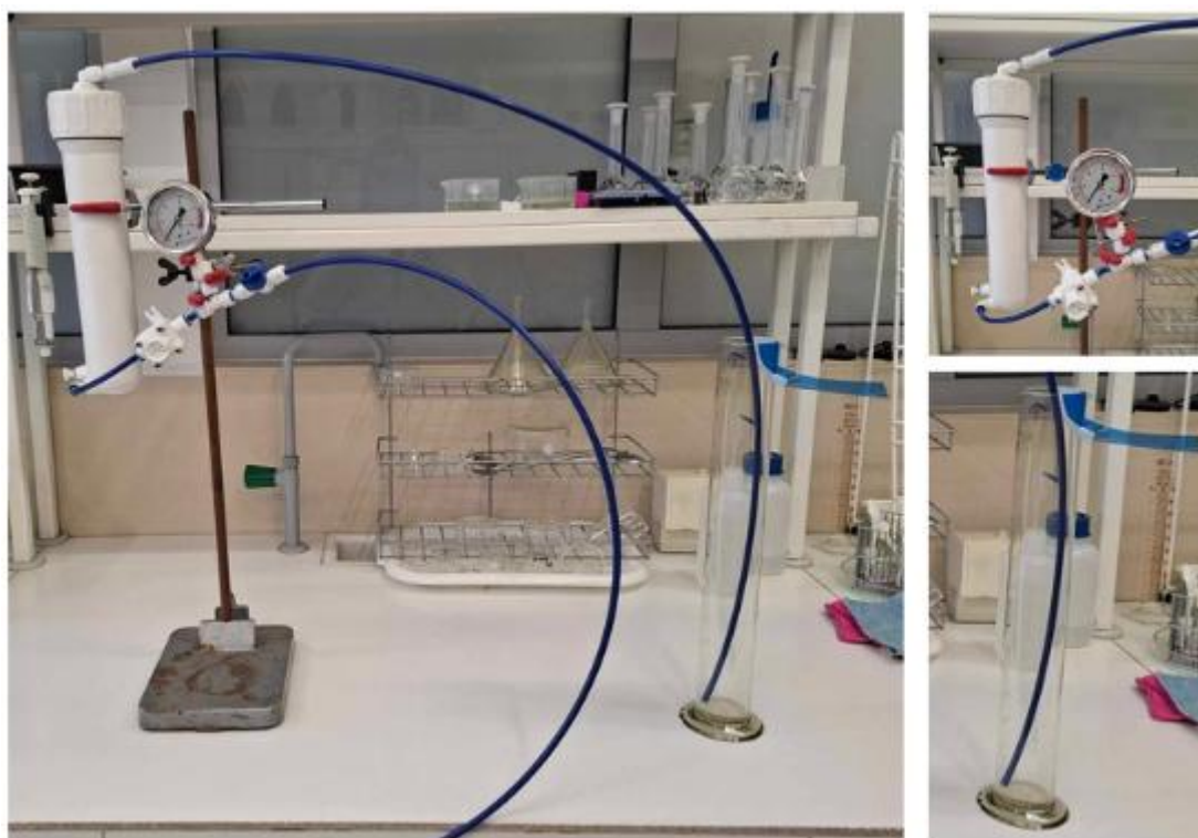
Rys. 5.12. Zestaw do flotacji ciśnieniowej wykorzystany w badaniach
