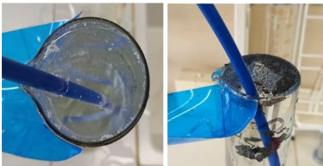
Rys. 5.16. Flotacja ciśnieniowa: tworzywa sztuczne unoszące się na powierzchni cieczy
