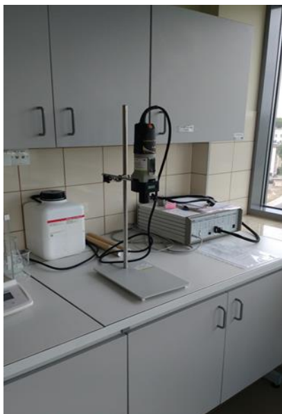
Rysunek 5.13 Homogenizer wirnikowy CatUnidrive 1000D zlokalizowany w Filii KUL w Stalowej Woli (fot. autor)
