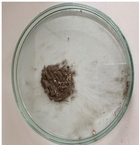
Rysunek 5.25 Stabilizat zmielony młyn tnący (fot. autor)
