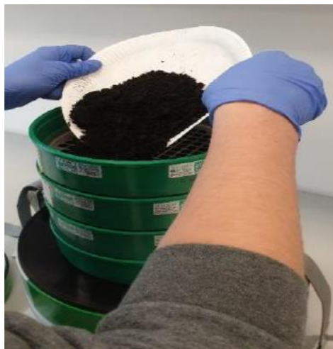
Rysunek 5.2 Próbkę kompostu nakładana do wytrząsarki lab. (fot. autor)
