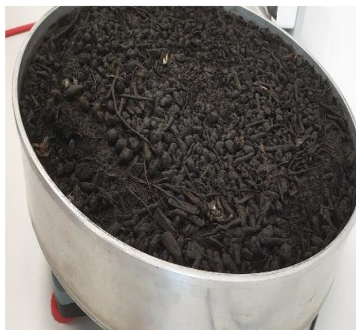
Rysunek 5.3 Próbkę analizowanego nawozu z MBP przygotowywana do analizy frakcyjnej (fot. autor)
