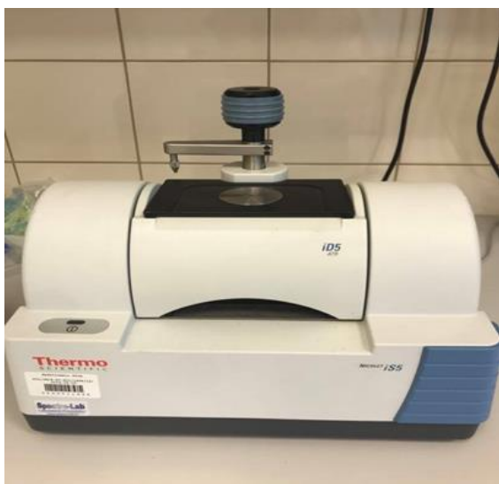
Rysunek 5.20 Spektrometr FT-IR ATR znajdujący się w Filii KUL w Stalowej Woli (fot. autor)
