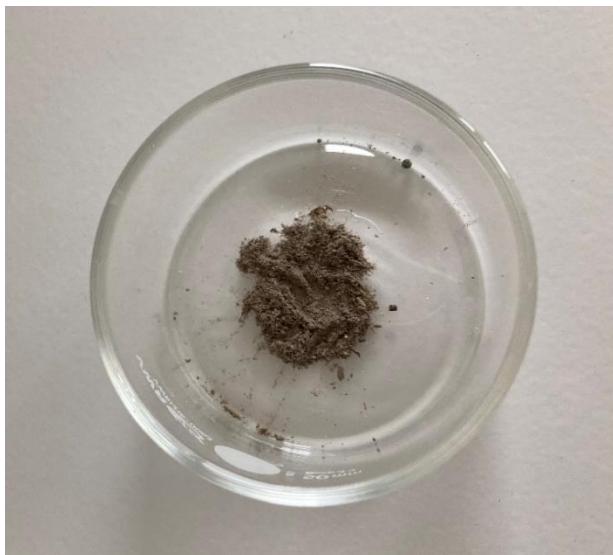
Rysunek 5.32 Stabilizat zmielony – młyn planetarno - kulowy (fot. autor)
