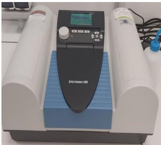
Rysunek 5.7 Spektrofotometr użyty do pomiaru zawartości fosforanów (fot. autor)
