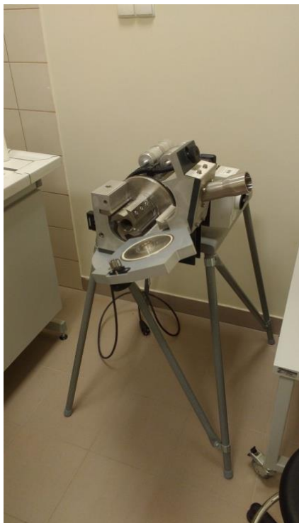
Rysunek 5.21 Młyn tnący znajdujący się w Filii KUL w Stalowej Woli (fot. autor)
