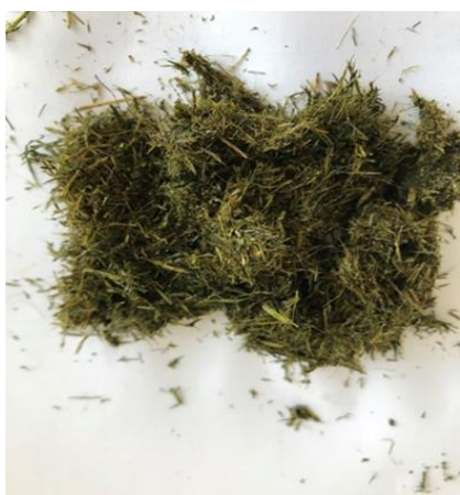
Rysunek 5.22 Kompostowana trawa zmielona w młynie tnącym (fot. autor)
