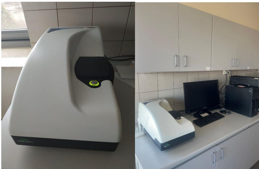
Rysunek 5.12 Analizator wielkości cząstek - Zetasizer Nano ZS Malvern znajdujący się w Filii KUL w Stalowej Woli (fot. autor)
