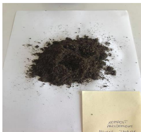
Rysunek 5.23 Kompost przydomowy zmielony w młynie tnącym (fot. autor)
