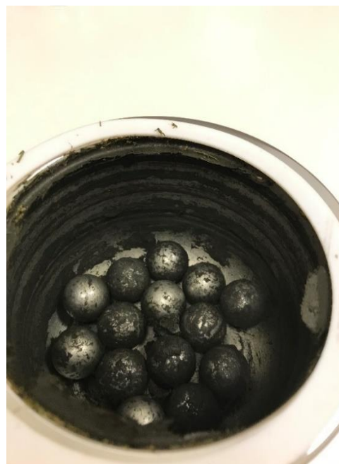
Rysunek 5.28 Kompostowana trawa zmielona w młynie planetarno-kulowym (fot. autor)
