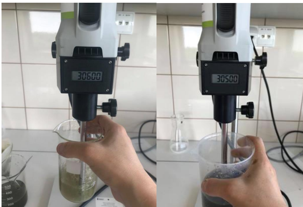
Rysunek 5.14 Homogenizacja przykładowych próbek – obroty ok. 30000, czas około 1 min (fot. autor)
