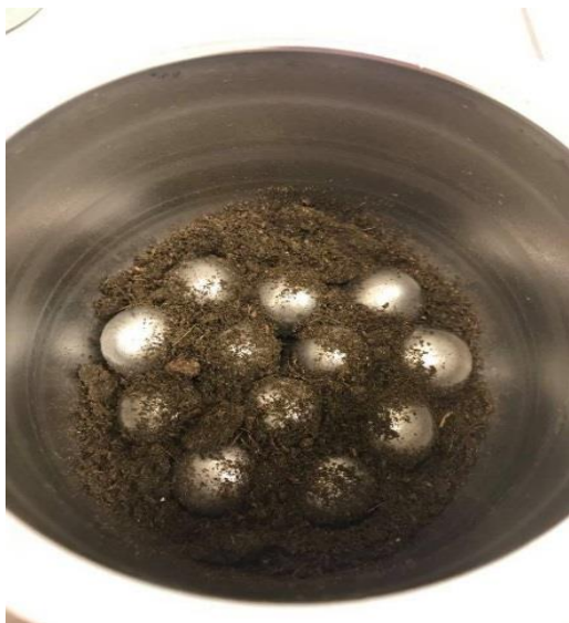
Rysunek 5.29 Kompost przydomowy gotowy do mielenia w misie od młyna planetarno-kulowego (fot. autor)
