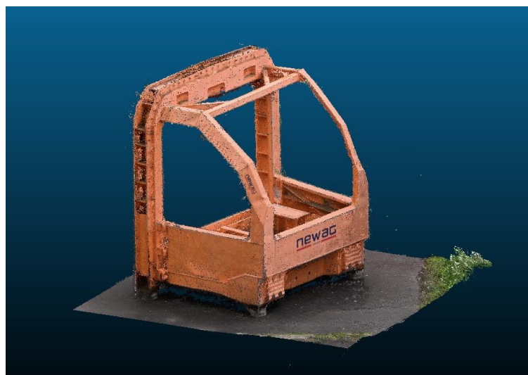
Rys. 5.15. Chmura punktów uzyskana reprezentująca analizowaną kabinę, zrzut ekranu wykonany w programie CloudCompare
