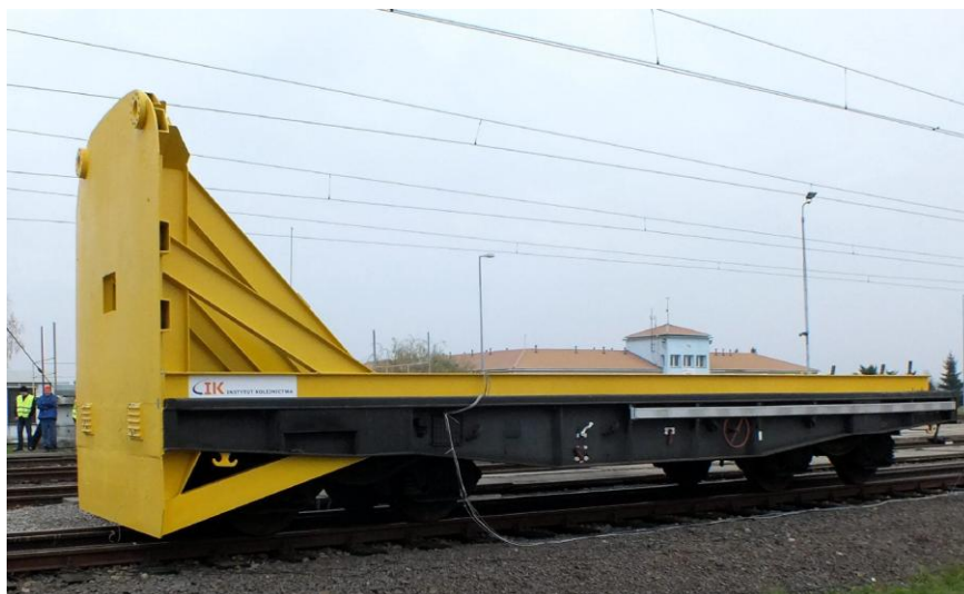
Rys. 5.20. Wagon oporowy z przyspawanymi elementami zabezpieczającymi przed wspinaniem
