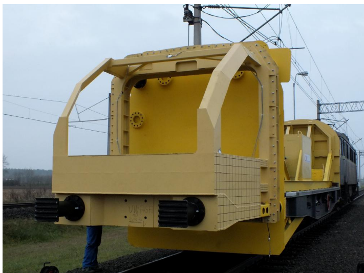
Rys. 5.19. Wagon najeżdżający „taran” z zamontowaną kabiną wyposażoną w absorbery boczne
