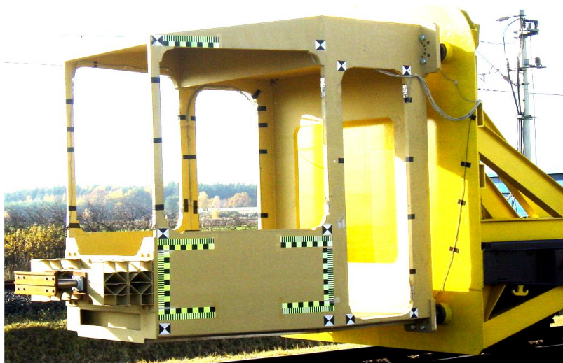
Rys. 6.9. Kabina testowa tramwaju miejskiego (CT) w projekcie SAFETRAM
