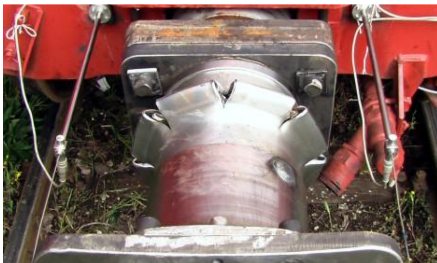
Rys. 3.16. Plastycznie zdeformowany absorber boczny „crash” [77]
