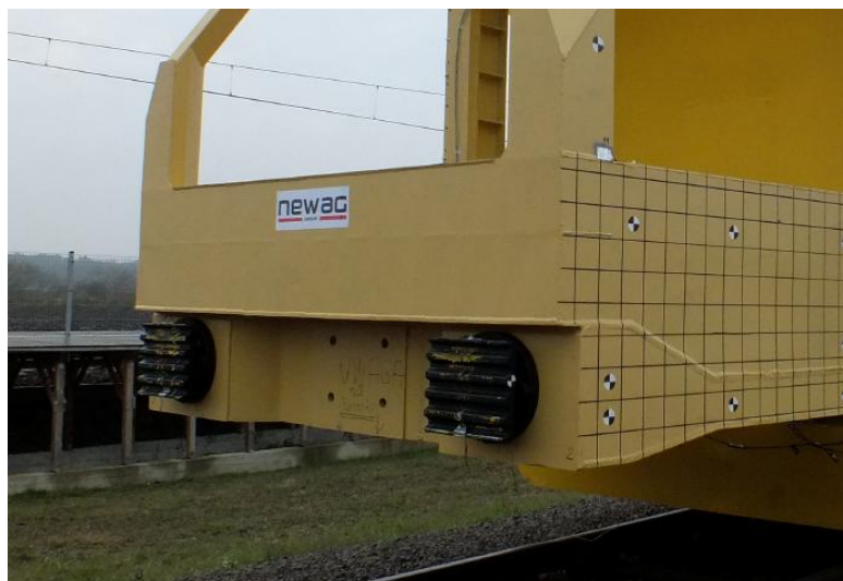
Rys. 5.22. Zdeformowane absorbery boczne po zderzeniu pojazdów [135]
