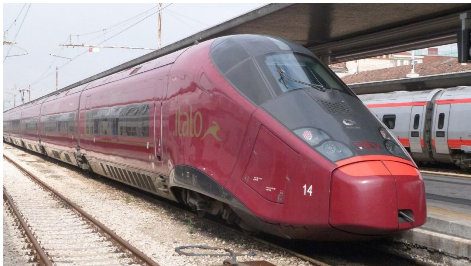
Rys. 3.25. Pociąg Alstom AGV 575 ze zgarniaczem ukośnym [114]
