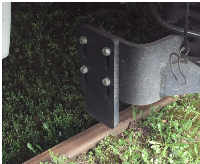
Rys. 3.26. Zgarniacz szynowy zamontowany na wózku pojazdu typu Impuls (zdj. A. Lisowska-Paluch)
