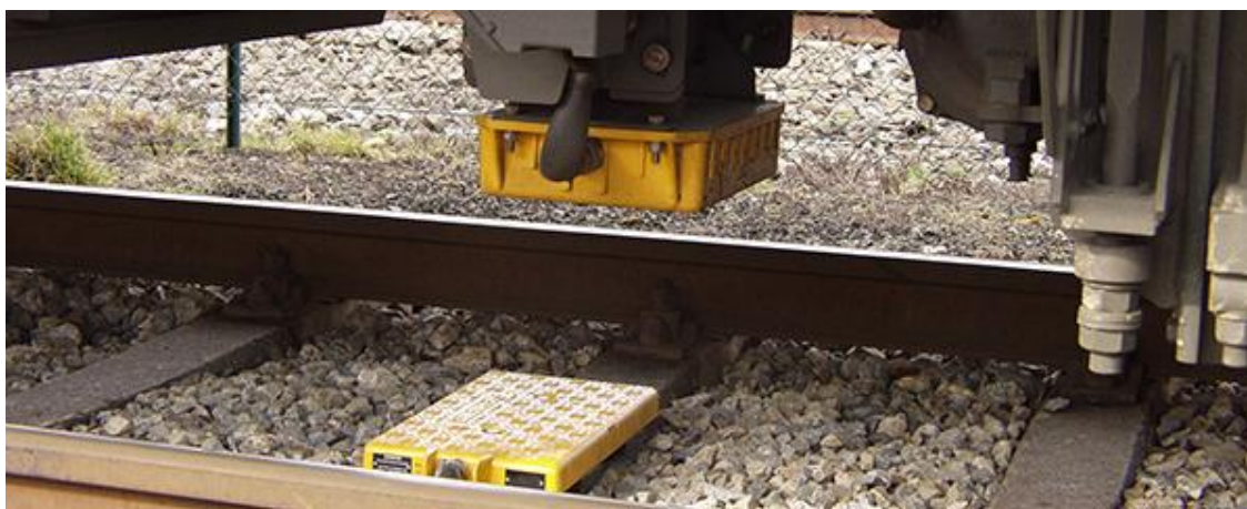
Rys. 3.14. Eurobalisa na torach kolejowych [59]
