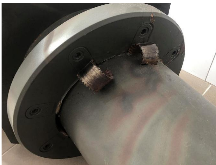
Rys. 3.18. Strugi metalu wykrawanego w korpusie zderzaka (zdj. A. Lisowska-Paluch)
