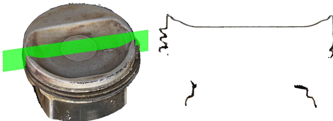
Rys. 5.11. Przekrój modelu tłoka i kształt płaszczyzny tłoka w tym przekroju
