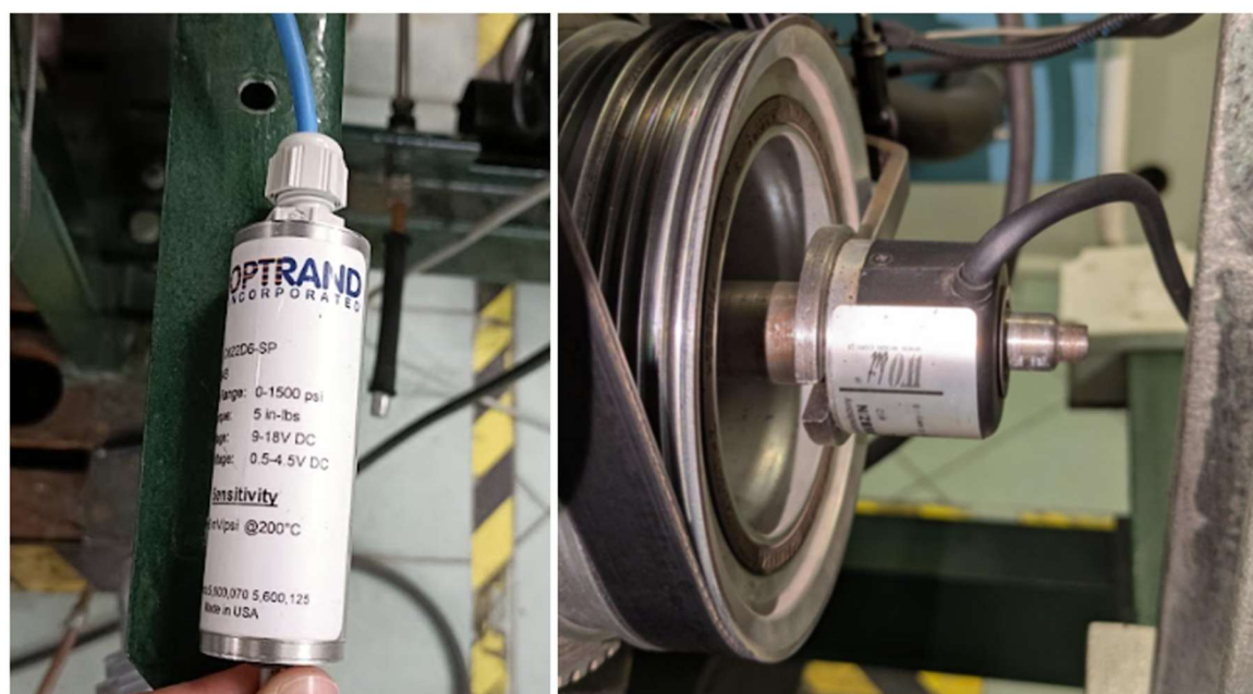
Rys. 5.14. Czujnik ciśnienia Optrand i enkoder MHK40 na stanowisku badawczym
