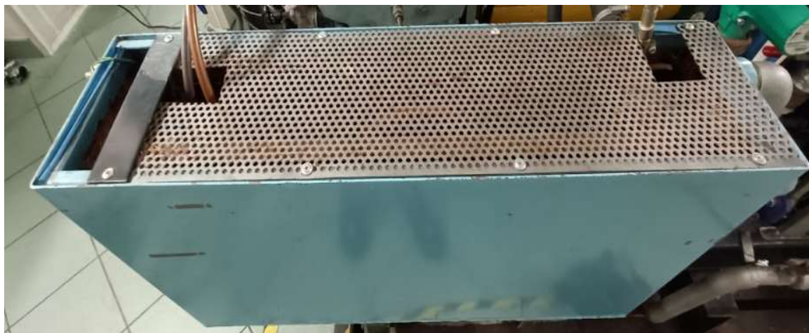
Rys. 5.19. Wymiennik ciepła wykorzystany do chłodzenia recyrkulowanych spalin
