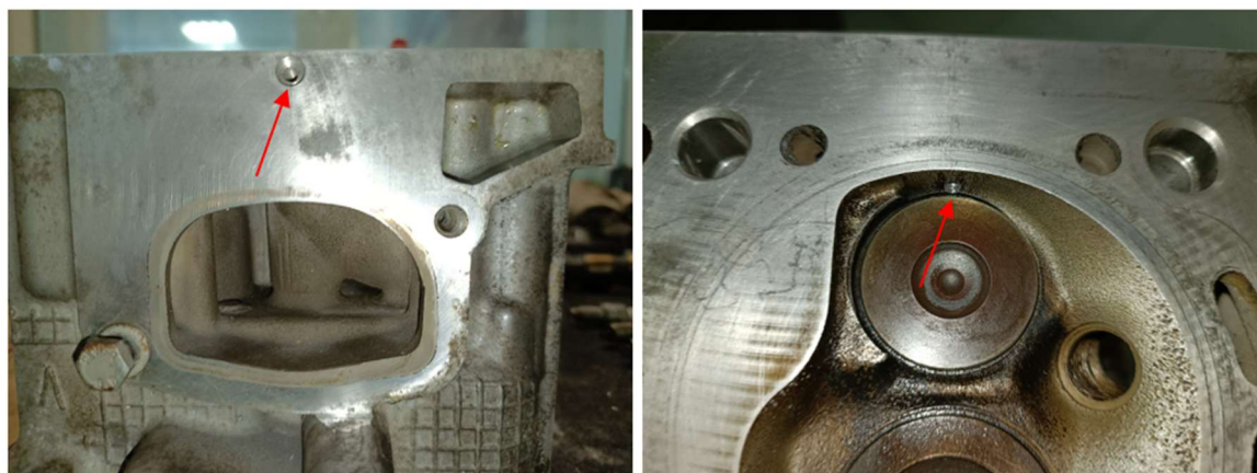
Rys. 5.3. Głowica z przygotowanym otworem na czujnik ciśnienia (materiały własne)
