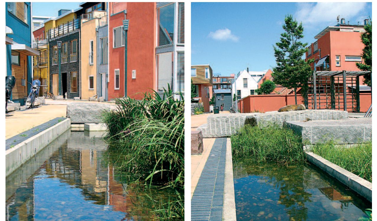
Il. 4. Woda deszczowa gromadzona jest w niewielkich zbiornikach wodnych na dziedzińcach i placach. Rainwater is collected in small reservoirs in the yards and squares.
