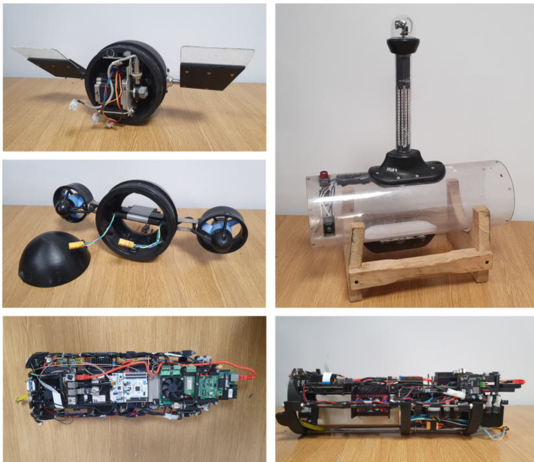
Rysunek 4.3. Dziób, rufa, kadłub oraz moduł elektroniki pojazdu HUUV.
