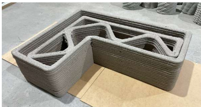
Rysunek 11 Prefabrykaty ścienne: a) typ A, b) typ B- wykonane w technologii druku 3DCP z opracowanego w ramach pracy betonu drobnoziarnistego.
