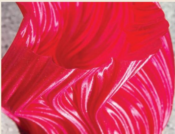
Przykład cienkościennego wydruku filamentowego Fot.: Michał Pierewicz
