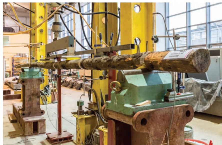
Stanowisko badawcze w laboratorium podczas badań oryginalnej krokwi Fot.: Bartłomiej Krcha
