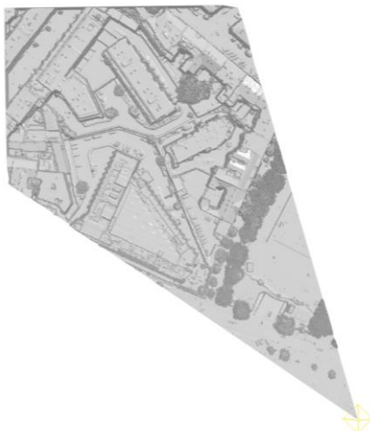
Fig. 57 Powierzchnia TIN na bazie radialnego wycinka chmury punktów wraz z punktem świetlnym
