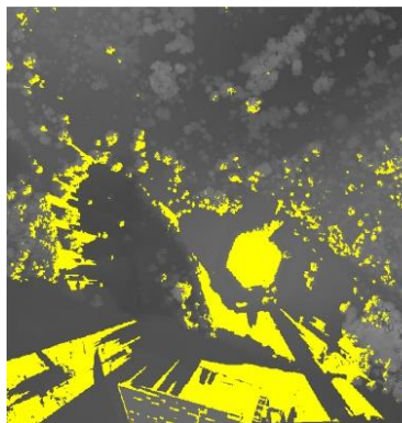
Fig. 37 Wykres widoczności bazujący na NMPT
