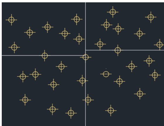
Fig. 91 Kolejny podział wedle punktów znajdujących w medianach dla lewego i prawego poddrzewa wyznaczonych po osi Y
