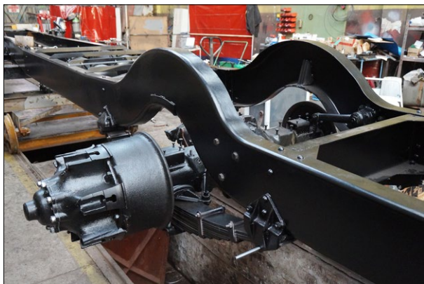
Ryc. 4. Podwozie autobusu w trakcie remontu, po pierwszym lakierowaniu (drugie wykonano po montażu jednostki napędowej i większości innych podzespołów) – ogólny widok tylnej części ramy wraz z zamontowanym tylnym mostem, piastami i resorami; fot. K. Kołodziejczyk, 2020
