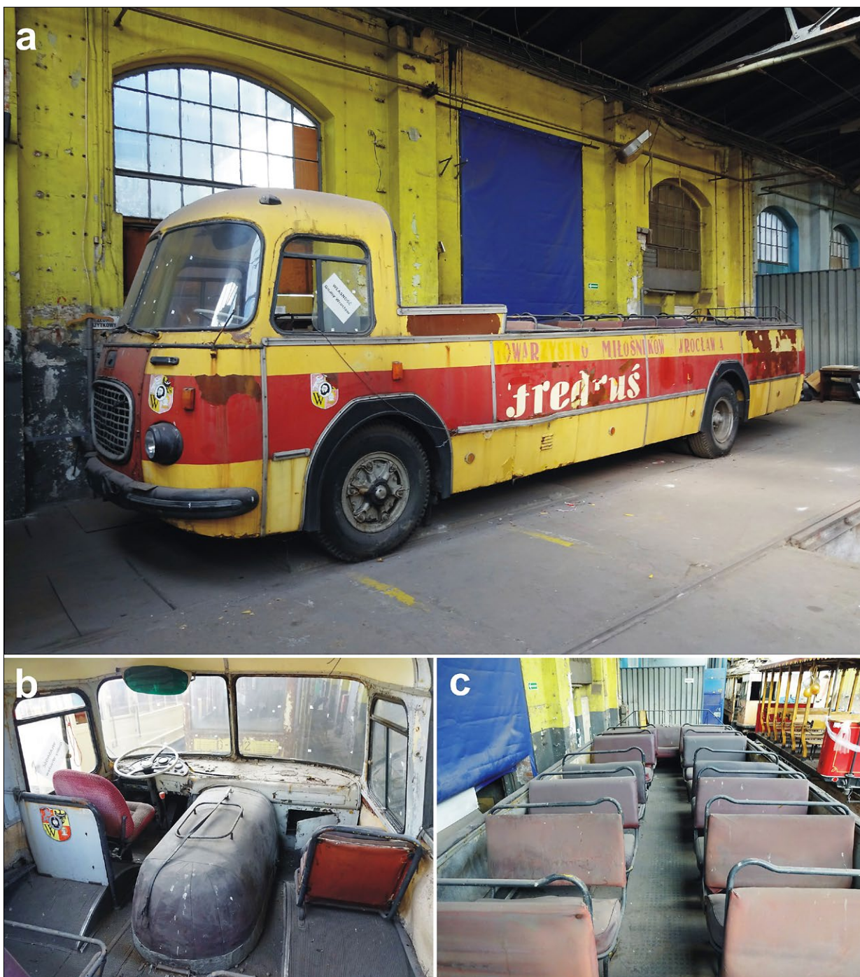
Ryc. 2. Stan pojazdu przed remontem: a) widok ogólny, b) stanowisko kierowcy i pokrywa silnika, c) wnętrze z siedzeniami pasażerskimi; fot. K. Kołodziejczyk, 2020
