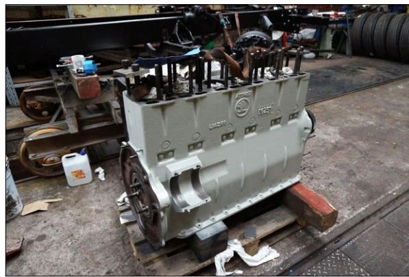
Ryc. 5. Pomalowany blok silnika podczas uzbrajania w wyremontowane, zregenerowane lub nowe podzespoły; dobrze widoczny znaczek Škody oraz oznaczenie LIAZ (Liberecké Automobilové Závody, gdzie od 1951 r. prowadzono część produkcji Škody); fot. K. Kołodziejczyk, 2020
