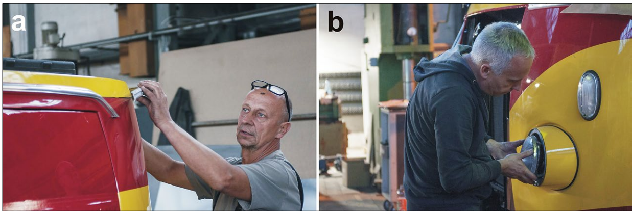
Ryc. 8. Autobus na końcowym etapie restauracji: a) montaż listew ozdobnych w tylnej części, b) montaż reflektorów; fot. I. Jankowska, 2021 Fig. 8. Bus in the final stage of restoration: a) installation of decorative strips in the rear, b) installation of headlights; photo: I. Jankowska, 2021
