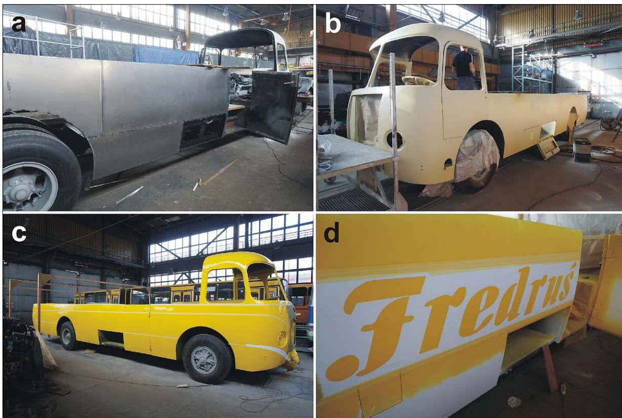
Ryc. 7. Remont poszycia zewnętrznego: a) prace przy nowym oblachowaniu, b) nadwozie pomalowane farbą podkładową, c) nadwozie po pokryciu żółtym lakierem i w trakcie przygotowań do położenia lakieru czerwonego – widoczne wykroje wyznaczające linie odcięcia jednego koloru od drugiego, d) szablon napisu „Fredruś” opracowany na podstawie fotografii archiwalnych (czcionka przy kolejnych malowaniach autobusu ulegała jednak pewnym zmianom); fot. K. Kołodziejczyk, 2021
