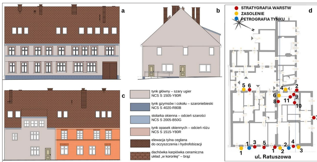
Ryc. 6. Projekt kolorystyki elewacji: a) elewacja frontowa od strony ul. Ratuszowej, b) elewacja północna, c) elewacja tylna, d) lokalizacja miejsc pobrania próbek do analizy na rzucie przyziemia; oprac. M. Tuszyński, K. Żywucki
